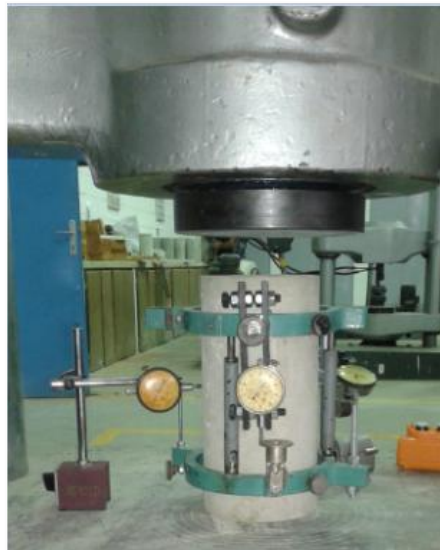
Figura III-10: Ensayo de compresión axial Fuente: Elaboración propia
