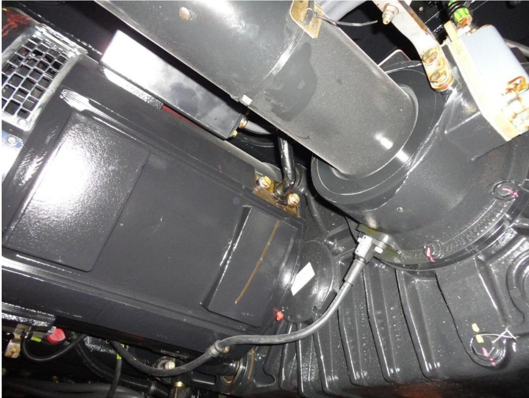
**Figura 16. Imagen inferior del Motor de Tracción**
