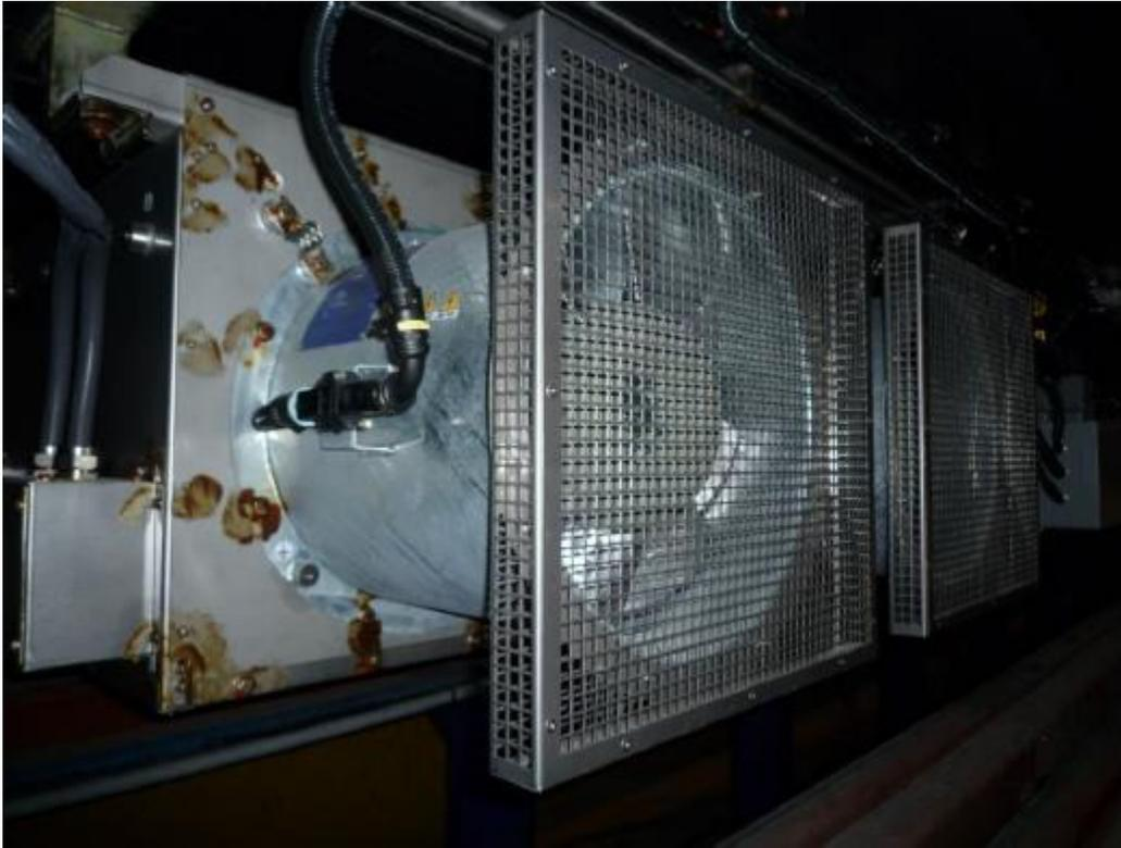
**Figura 13. Vista frontal de la Resistencia de Freno**
