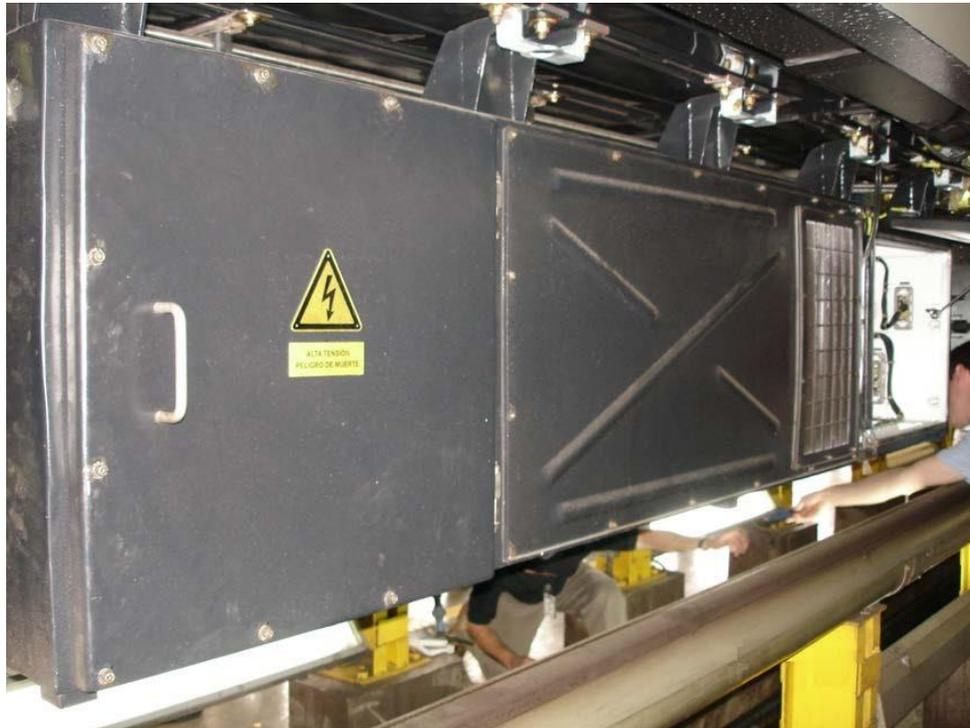
**Figura 7. Cofre Convertidor de Tracción**
