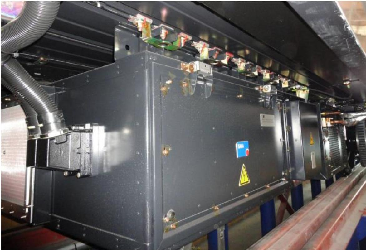
Figura 17. Convertidor Auxiliar
