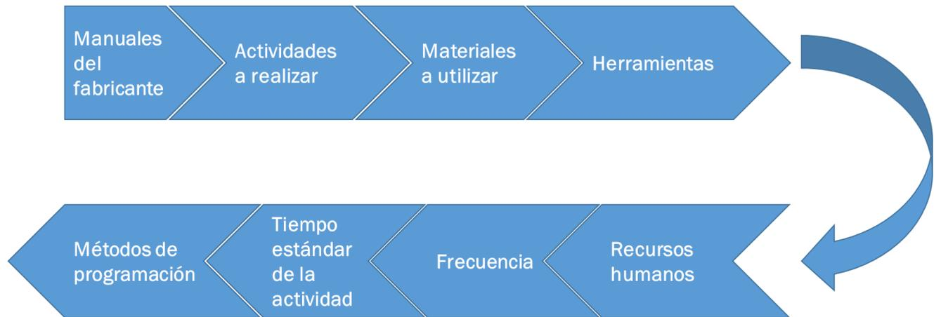
**Figura 1. Pasos a seguir en la programación del mantenimiento preventivo**
