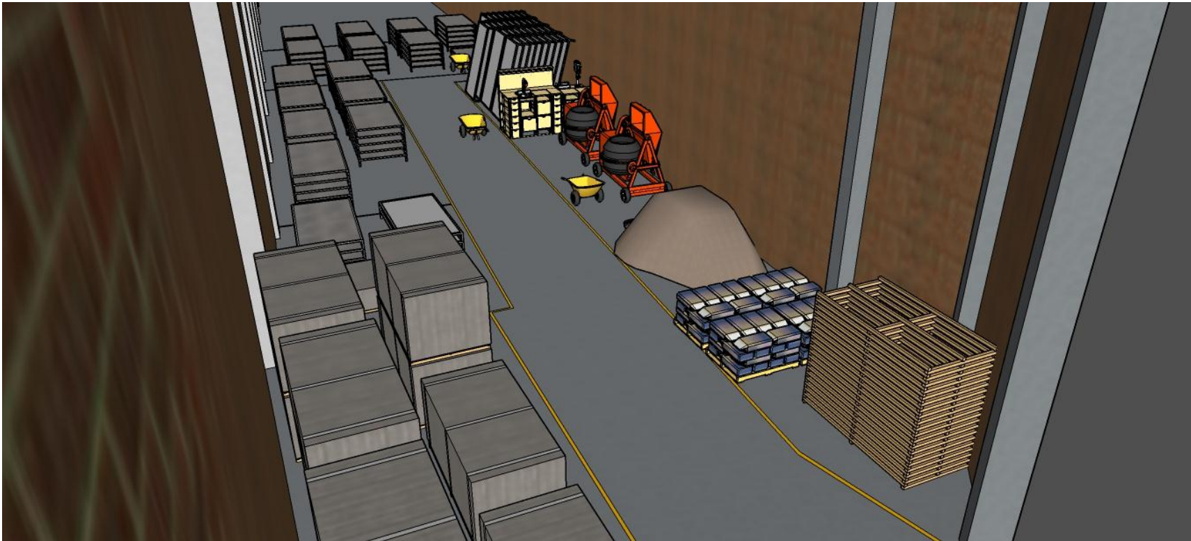
Figura 39. Diseño propuesto de la distribución para un sistema de producción manual.
