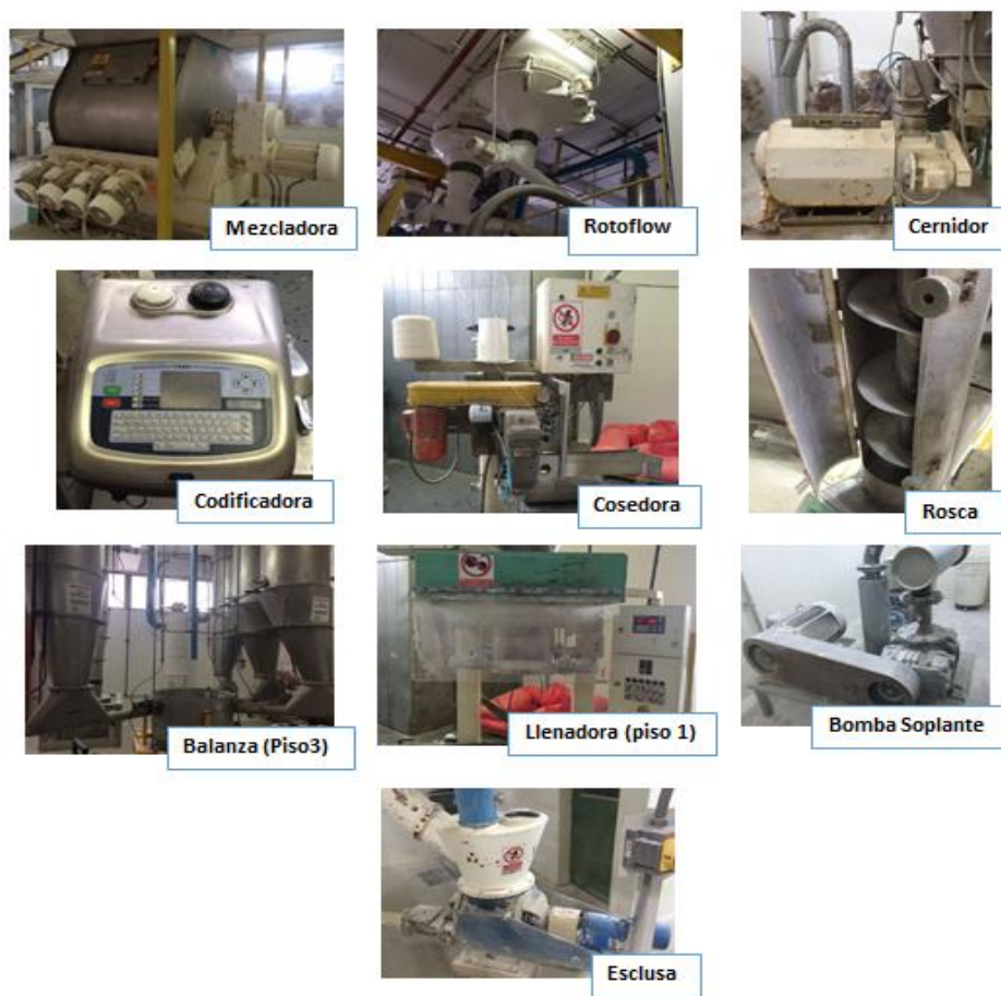
Ilustración 4: Equipos utilizados en el proceso de fabricación de Harina de Premezcla. Fuente: Elaboración Propia
