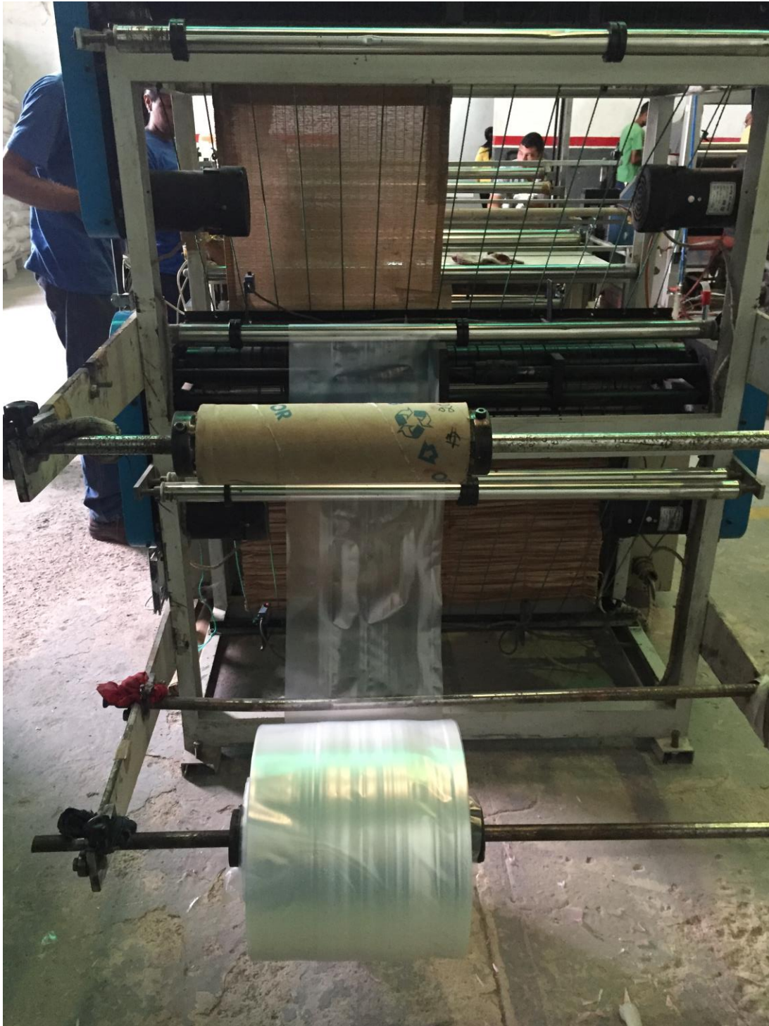
Figura B 3: Inicio del proceso “Sellado”
