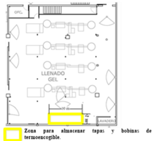
Figura 44: Zona para almacenar las tapas y bobinas de termoencogibles.
