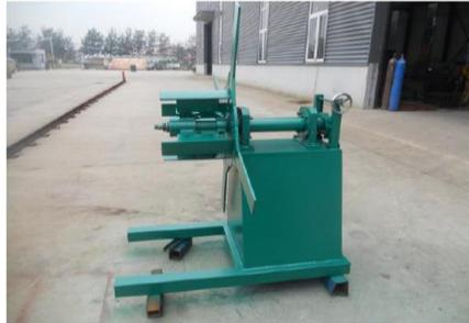
**Figura 8. Decoiler o desenrollador manual**
