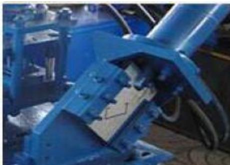
**Figura 13. Cizalla para perfiles de Drywall**
