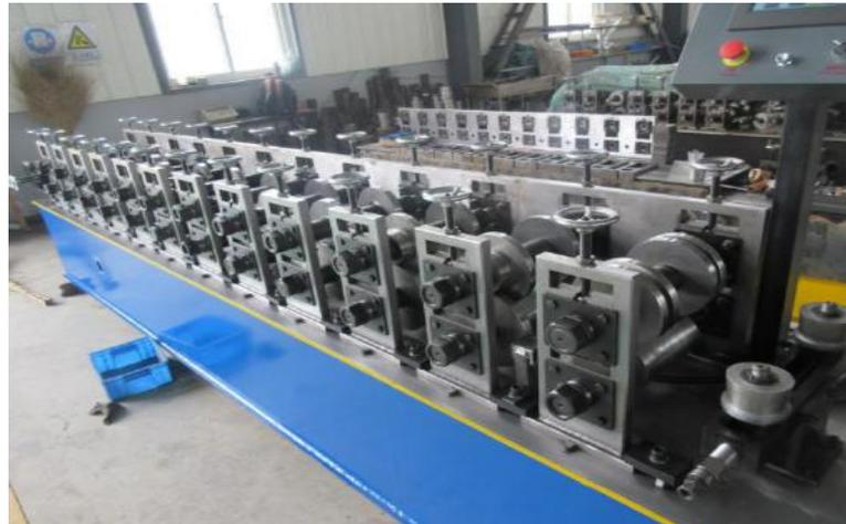
**Figura 10. Máquina perfiladora**
