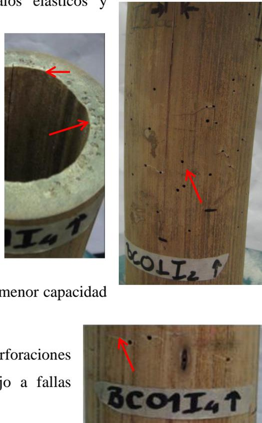
**Figura 4.22** Fallas producto de perforación de insectos.
