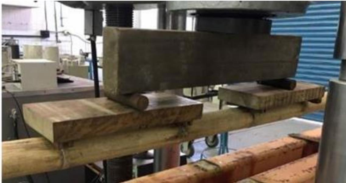
*Figura 4.13 Montaje de apoyos, cilindros y viga en contacto con el cabezal*
