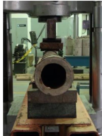
*Figura 1.3 Ensayos – Tensiones a Flexión.*
