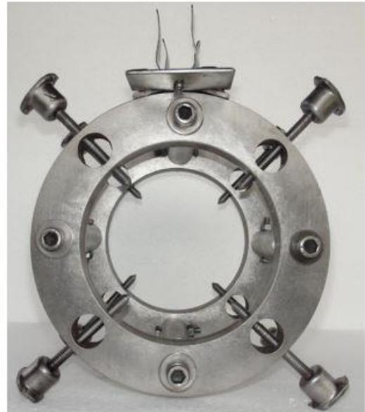
*Figura 4.2 Equipo para medición de deformaciones definitivo, vista lateral y vista en planta.*
