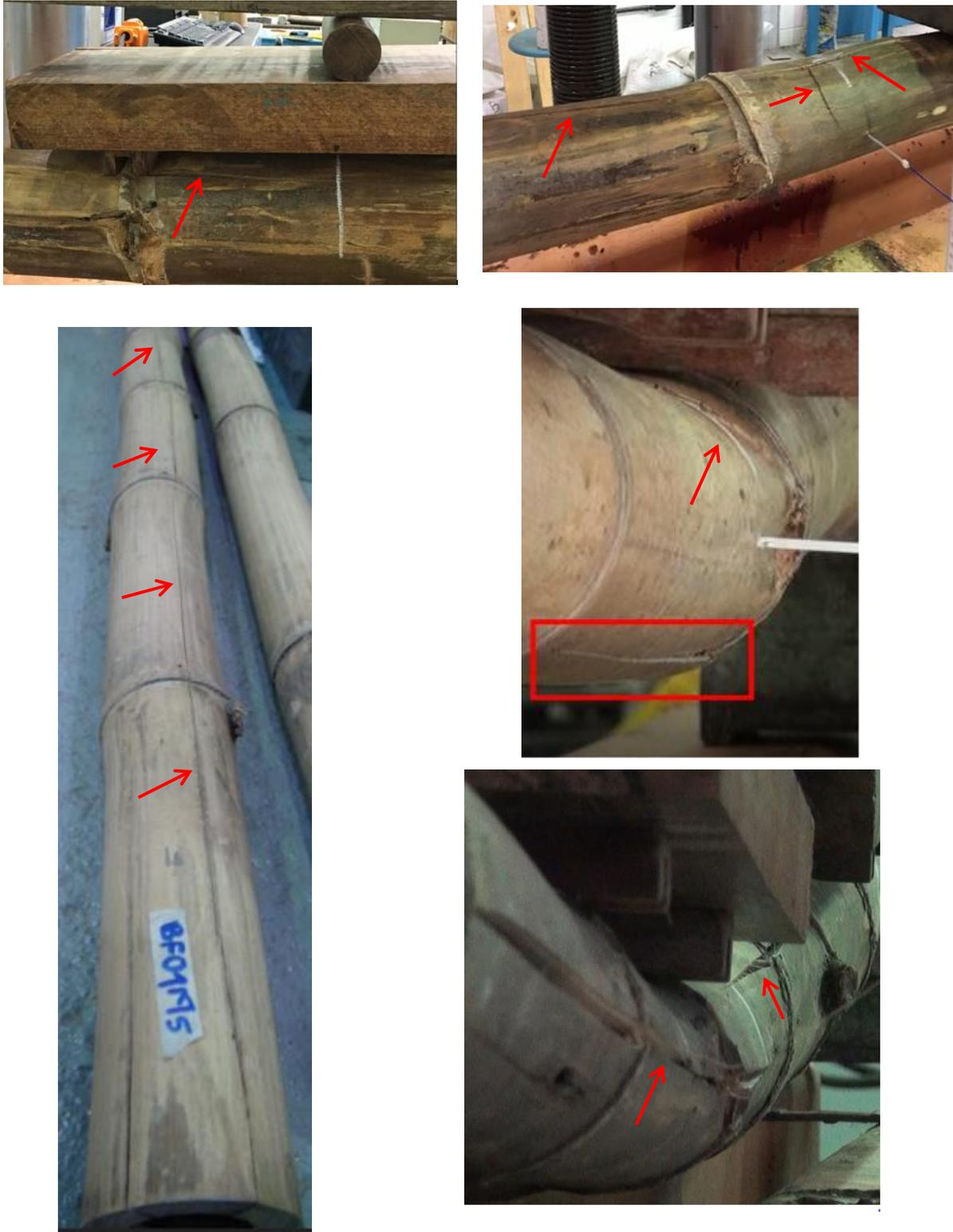
*Figura 4.30 Fallas por fisuras paralelas a las fibras.*
