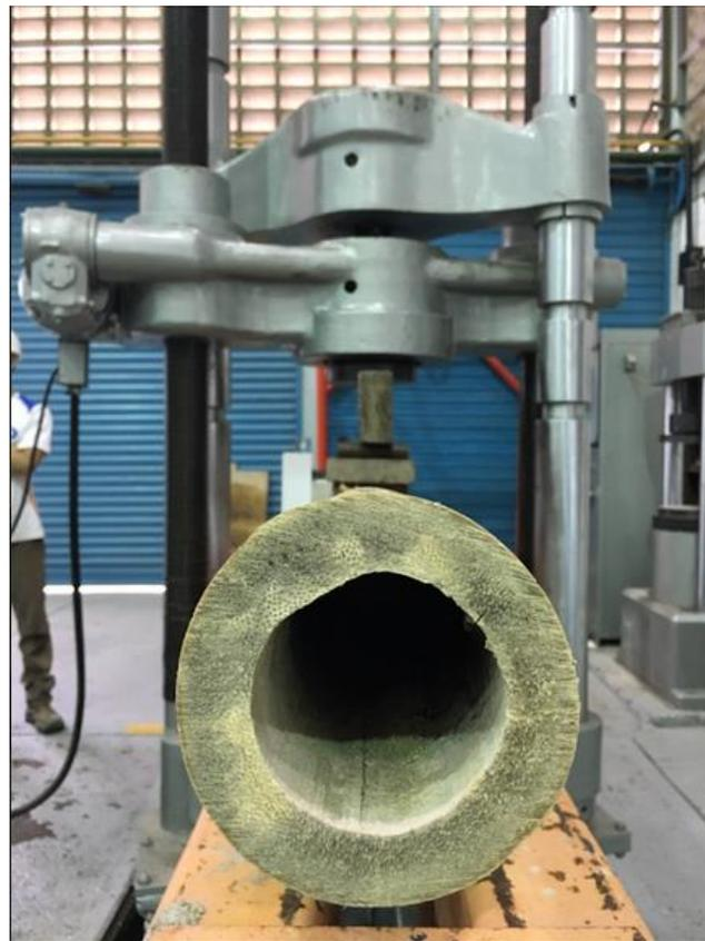
*Figura 3.14 Ensayo – Tensiones a flexión.*
