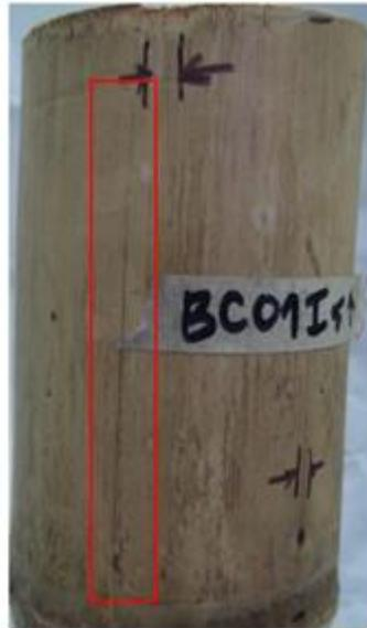
*Figura 4.20 Falla por tensión de las fibras superior interna y externa.*
