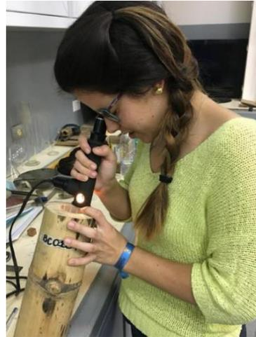
Figura 3. 5 Medición de espesores “efectivos”.
