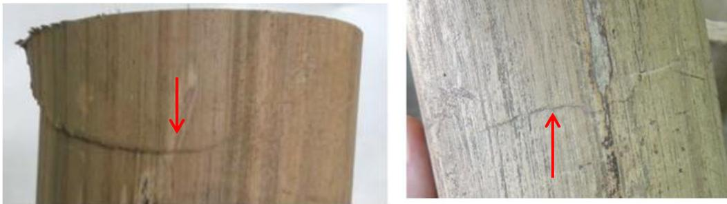
*Figura 4.17 Falla por corte, borde superior externo y falla por aplastamiento general de las fibras en dirección interna, borde inferior externo.*
