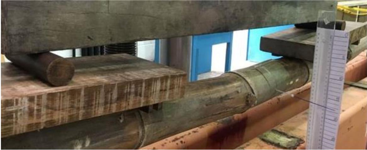
*Figura 3.9 Registro de deflexiones mediante el uso de la aguja y la regla calibrada.*
