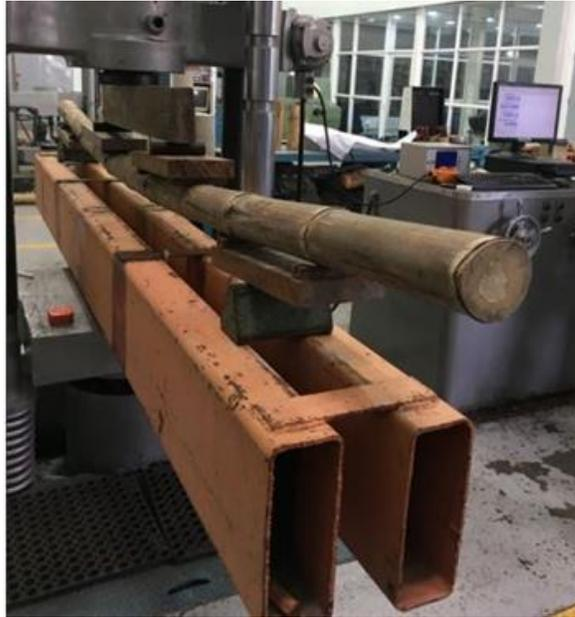
*Figura 4.15 Montaje para ensayo de tensiones a flexión.*
