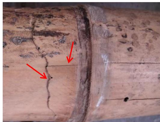
*Figura 4.26 Falla por corte y fisuras longitudinales*
