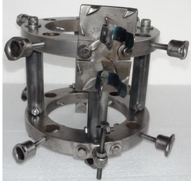
*Figura 4.3 Equipo para medición de deformaciones definitivo, vista de perfil.*
