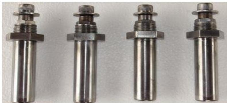
*Figura 4.7 Vástagos macizos de acero (pistones), arandelas de precisión y tornillos.*
