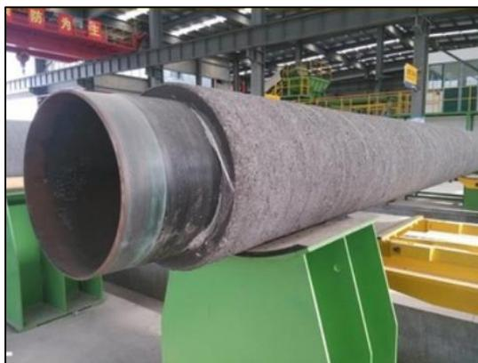
**Figura 17.** Tubería de acero recubierta con concreto.
