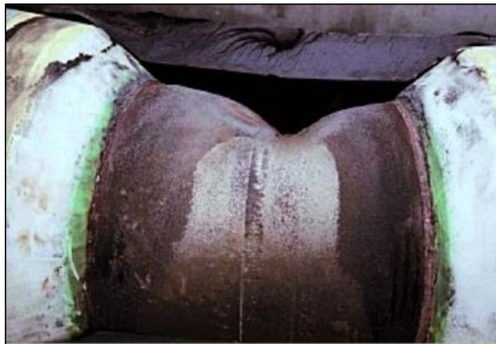
**Figura 19.** Pandeo Local en tubería submarina.
