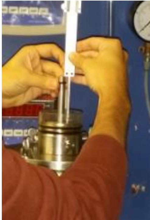
Figura 12: Medición de altura de vástago para calibración de CV.
