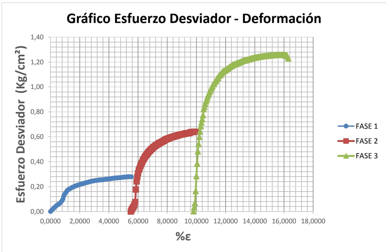
Gráfico 11: Esfuerzo Desviador - Deformación – Multifase. Muestra Charallave
