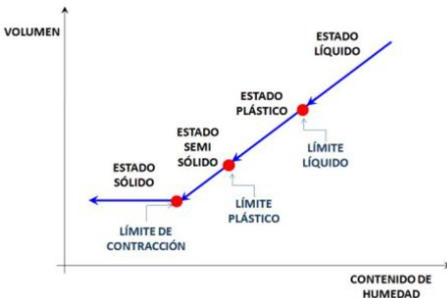
Figura 1: Variación del volumen en función del contenido de humedad.
