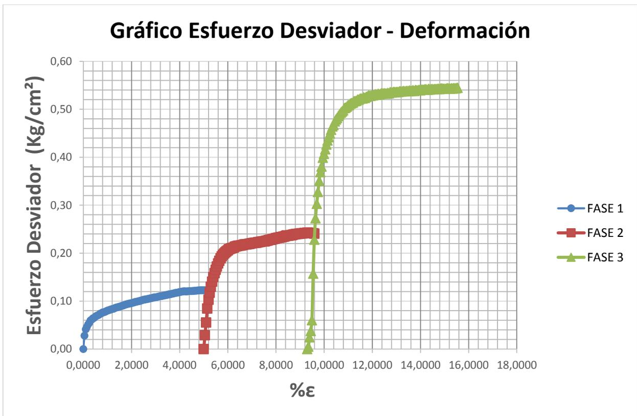
Gráfico 19: Esfuerzo Desviador - Deformación - Multifase. Muestra Barinas
