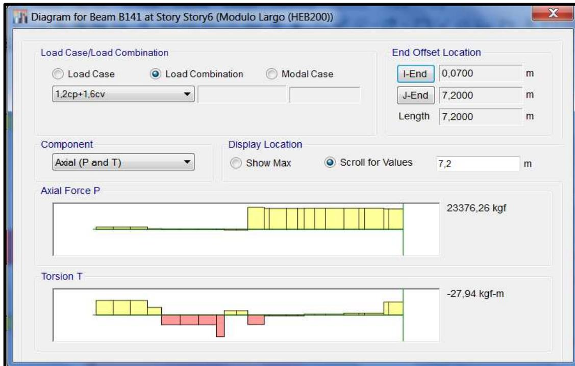
Figura 73: Fuerza Axial Pu de Diseño Techo Módulo Recto
