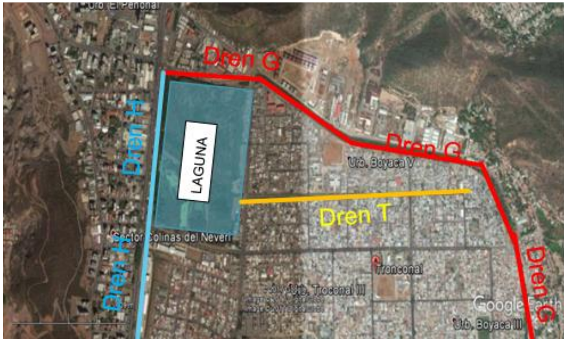
Figura 4.1. Retícula de drenes del sistema hidráulico.
