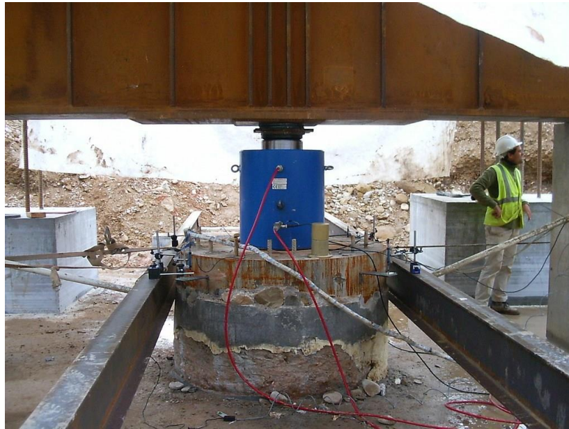
Figura 30. Prueba estática para estimar la capacidad portante.
