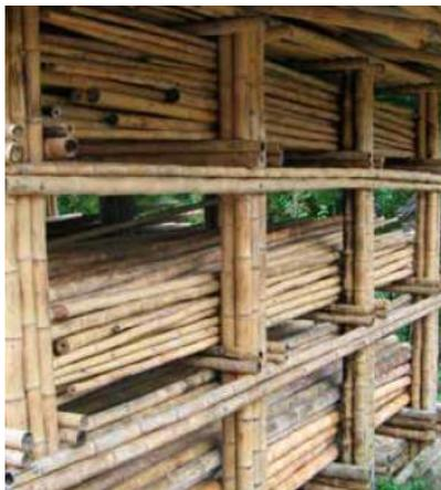
Figura 23. Secado bajo techo
