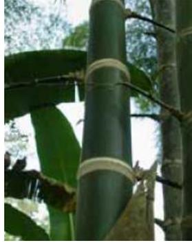
Figura 16. Bambú verde (no permitido su uso en construcción)
