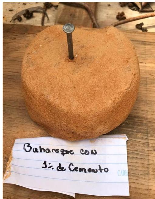
Figura 56. Muestra para prueba de resistencia
