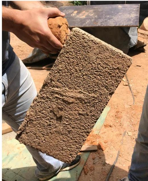
Figura 58. 2da Prueba de peso de 5kg con clavo
