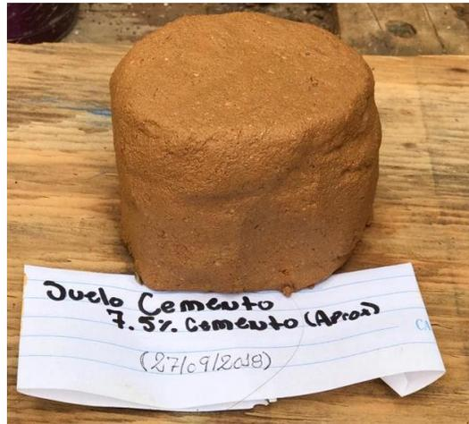
Figura 43. Muestra para prueba de resistencia
