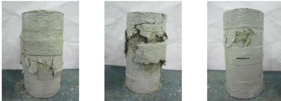
**Figura 16.** Probetas con 3 anillos ensayadas.
