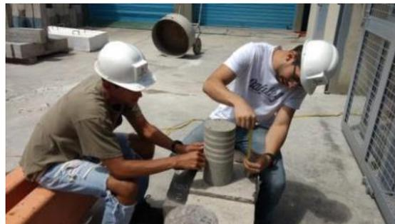
**Figura 11.** Preparación de probetas.
