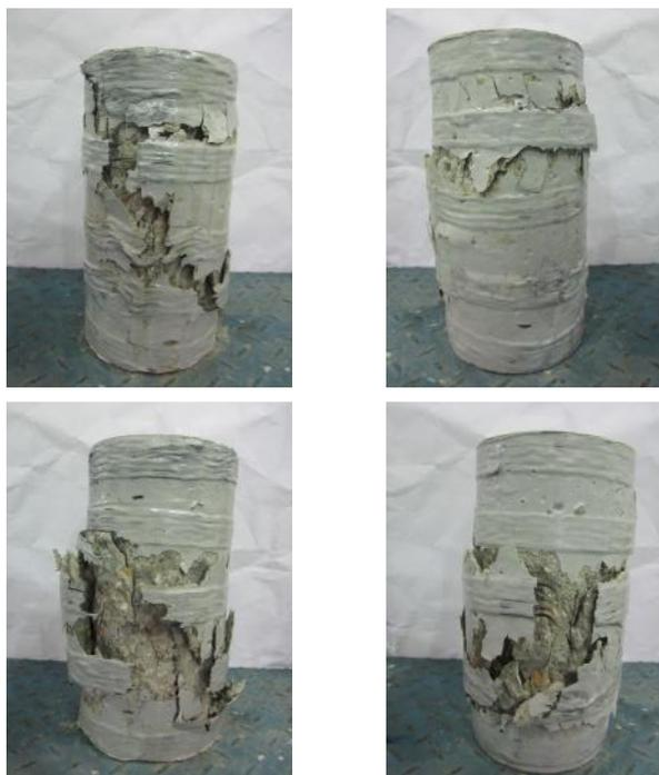
**Figura 18.** Probetas con 5 anillos ensayadas.
