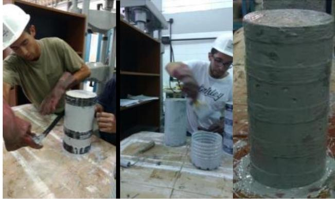
**Figura 12.** Colocación de la fibra de carbono (CFRP)
