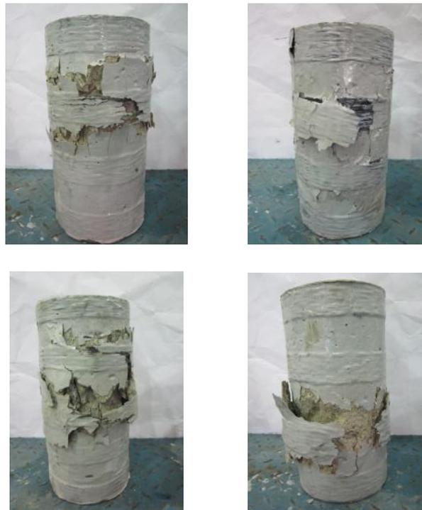
**Figura 20.** Probetas con 4 anillos ensayadas.
