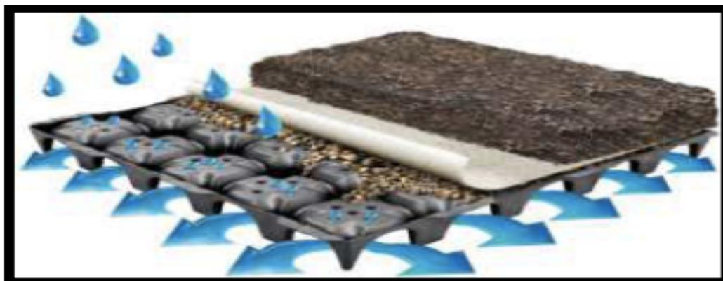
**Figura N°6 Paneles de irrigación y drenaje. (Fuente: Sustainablebuild).**
