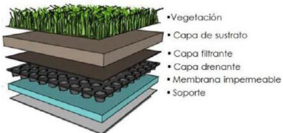
**Figura N° 1 Componentes de un techo Verde. (Fuente: de Mateo de Rhodes Valbuena(2012))**
