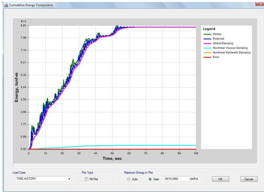
Figura 74. Energía disipada con disipador en disposición chevron. Fuente: Elaboración propia ETABS 2016.
