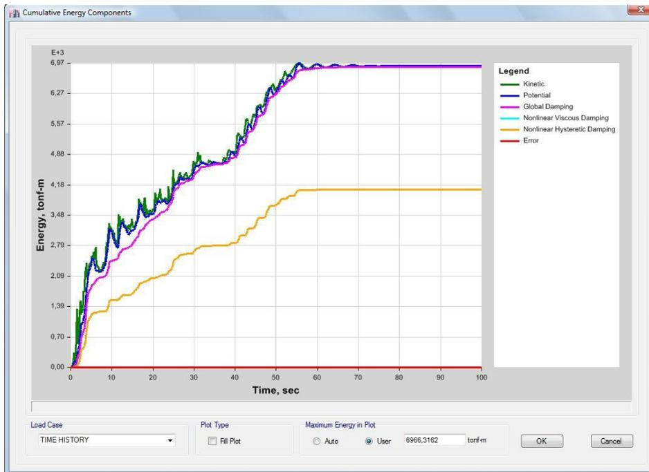
Figura 75. Energía disipada aislador núcleo de plomo. Fuente: Elaboración propia ETABS 2016.
