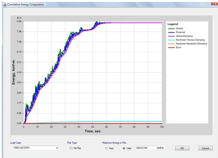
Figura 73. Energía disipada con disipador en disposición diagonal. Fuente: Elaboración propia ETABS 2016.
