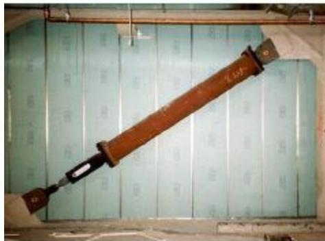
Figura 25. Disposición Diagonal. Fuente FEMA 273-274.
