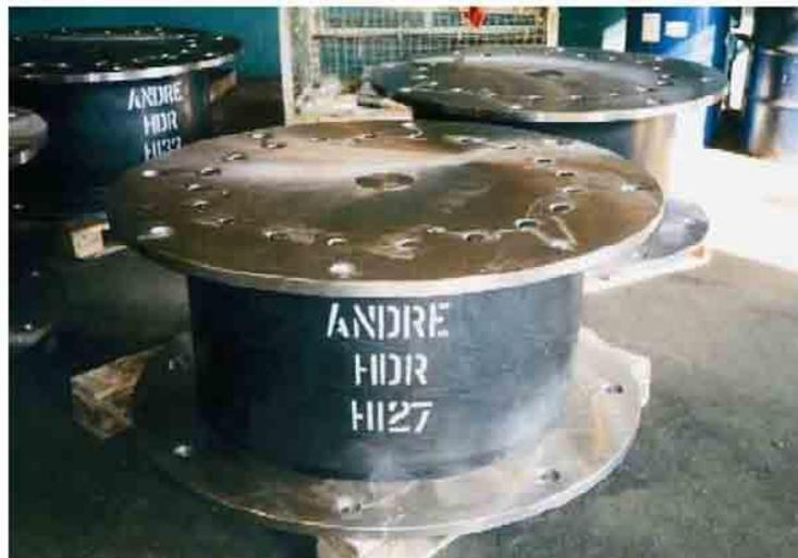
Figura 38. Aislador Elastomérico HDR. Fuente Arriagada, Jaime 2005. Chile.
