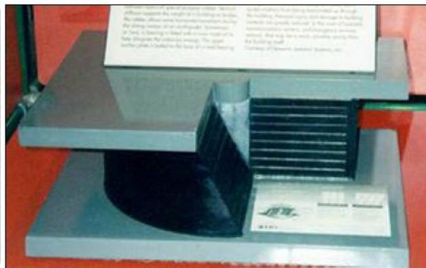
Figura 36. Esquema de un aislador elastomérico. Fuente: FEMA 273-274.
