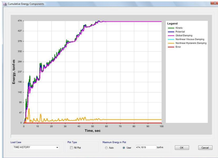
Figura 63. Diagrama de energía disipada aislador núcleo de plomo. Fuente: Elaboración propia ETABS 2016.
