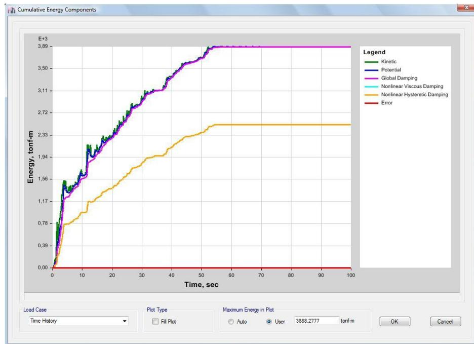
Figura 67. Energía disipada aislador núcleo de plomo. Fuente: Elaboración propia ETABS 2016.
