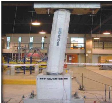
Figura 13. Disipador auto-centrante (biela). Fuente: Corporación de Desarrollo Tecnológico – Cámara Chilena de la Construcción. 2011.
