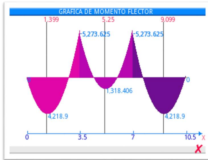
Figura 27. Diagrama de momento flector de la viga, (Programa Viga H, 2018).
