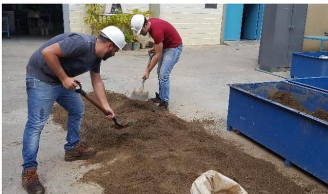
Figura 3.4: Homogeneización del Agregado Fino
