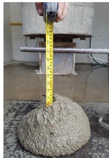
Figura 3.5: Medición de Asentamiento
