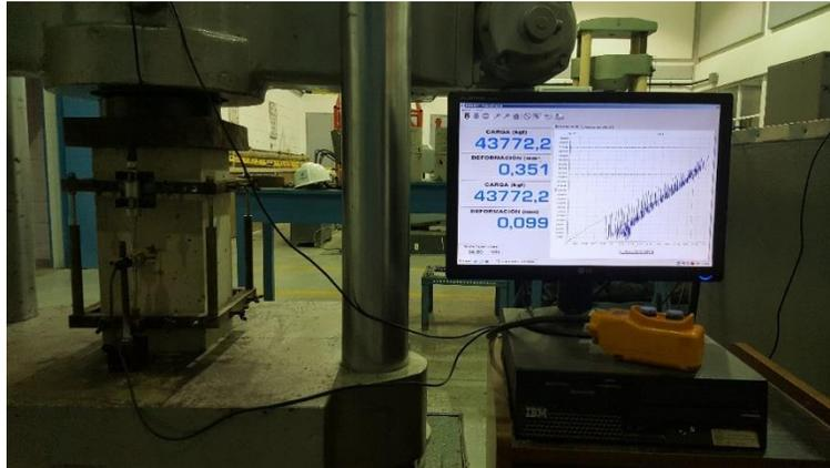
Figura 3.10: Ensayo de Carga Axial a Bajo Ciclaje
