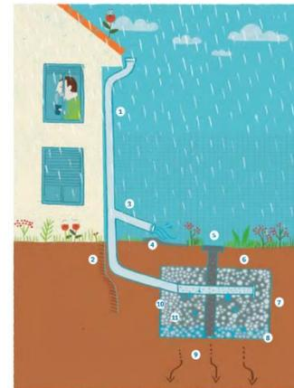
Figura N°15. Ejemplos de pozos de infiltración. Fuente: Ballester-Olmos, 2013 y Novaplas, 2018
