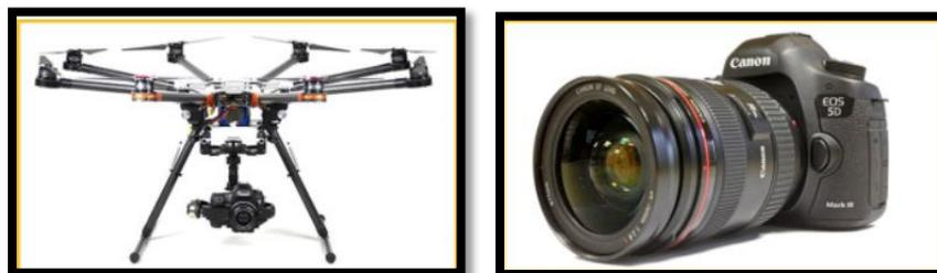
*Figura N°19.* Octacoptero con cámara Canon Mark III de 22 megapíxeles.
