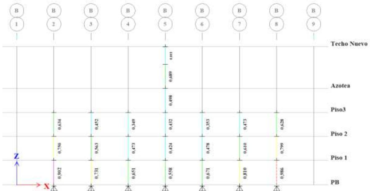
Figura # 62 (PMM Pórtico B Pórtico Diagonalizado AISC 360 y COVENIN 1756-2001)
