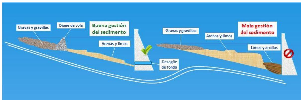
**Figura 19** Distribución de sedimentos en un embalse en función de la gestión de sedimentos que se efectúa
