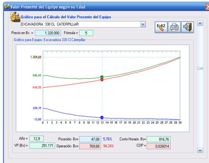
Figura 29. Curva de costo horario para excavadora.
