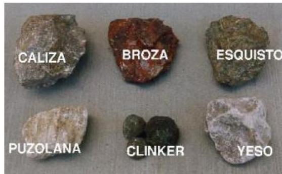
**Figura 4. Composición mineralógica del cemento**
