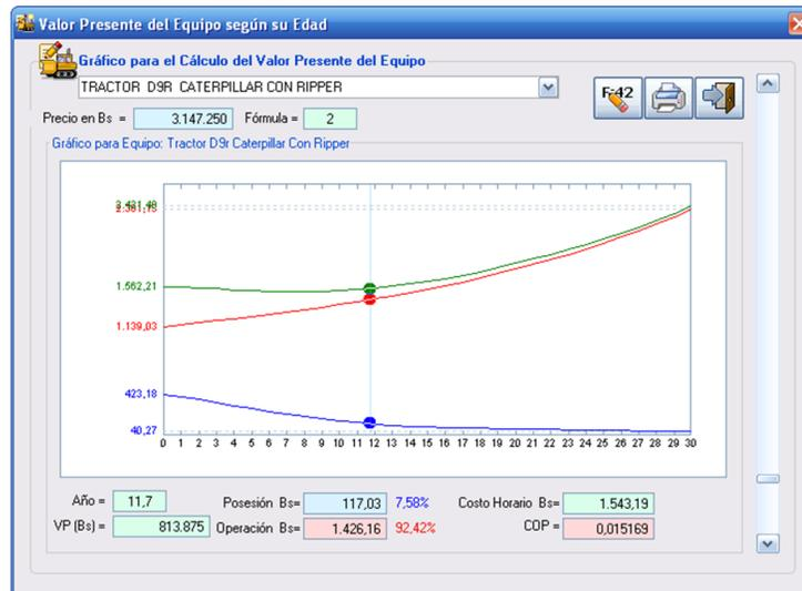
Figura 31. Curva de costo horario para tractor sobre orugas tipo D9
