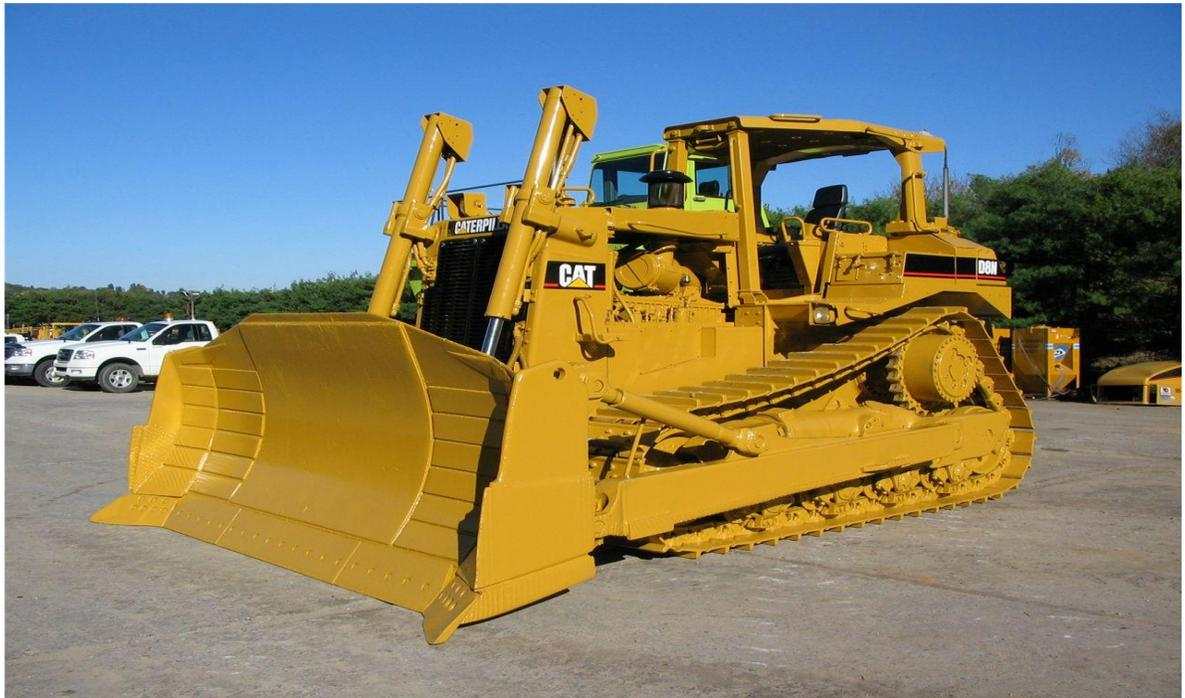
**Figura 12. Tractor sobre oruga. (Manual de Caterpillar)**
