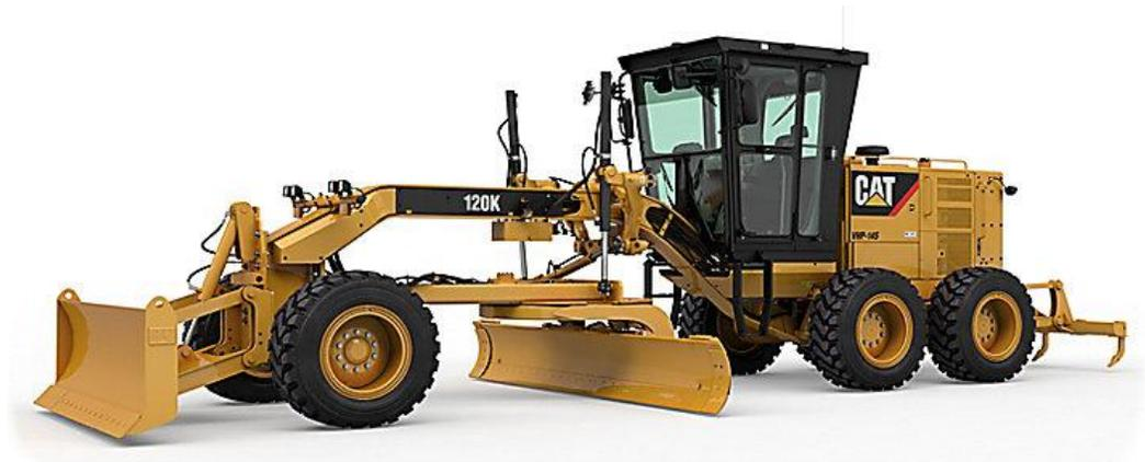
**Figura 13. Motoniveladora (Manual de Caterpillar)**
