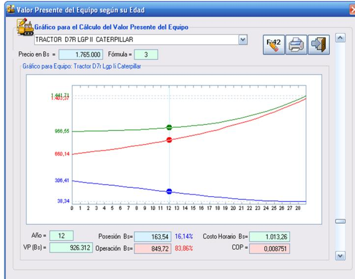
Figura 30. Curva de costo horario para tractor sobre oruga tipo D7
