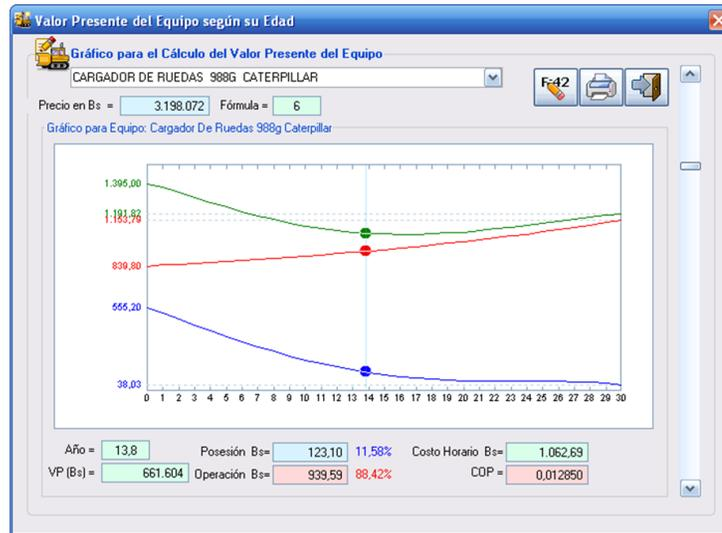
Figura 32. Curva de costo horario para cargador frontal sobre ruedas
