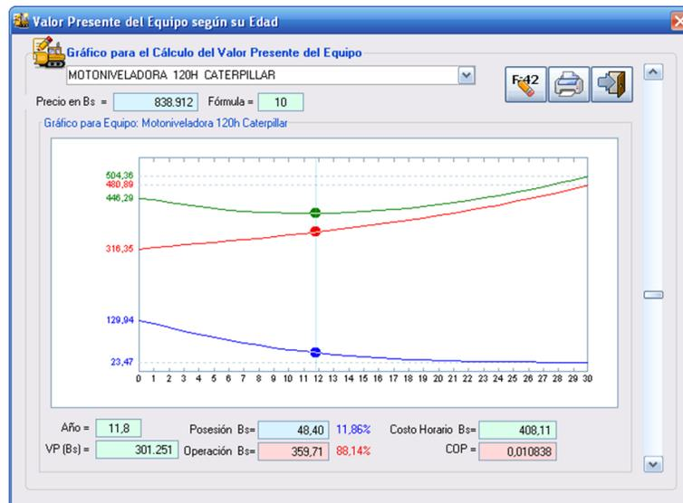
Figura 33. Curva de costo horario para motoniveladora.
