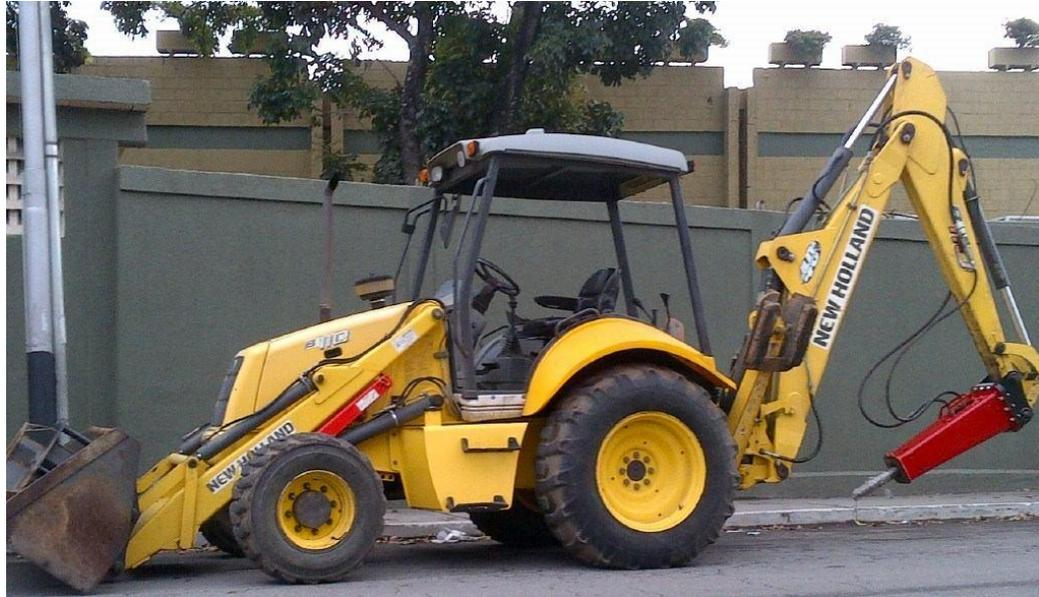
**Figura 17. Retroexcavadora con aplicación de martillo hidráulico. (Richard Marmani (2001).**
