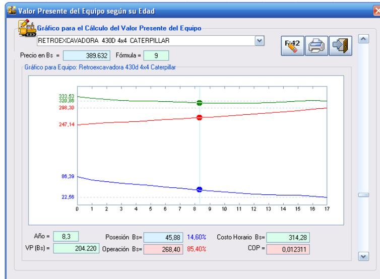
**Figura 34. Curva de costo horario para retroexcavador**
