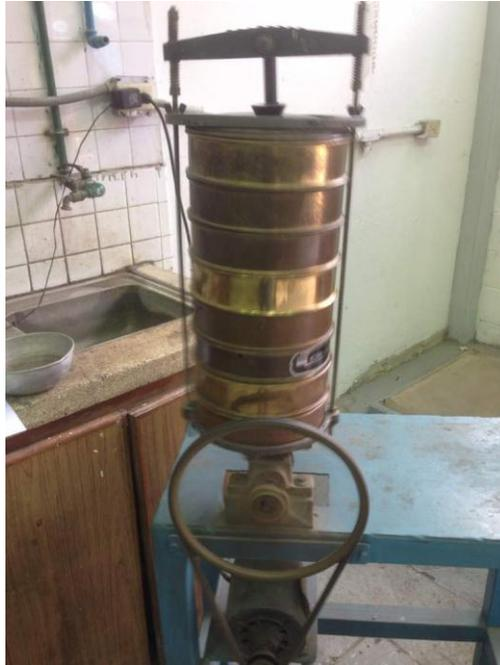
FIGURA 3.1. Tamizadora del Laboratorio de materiales UCAB
