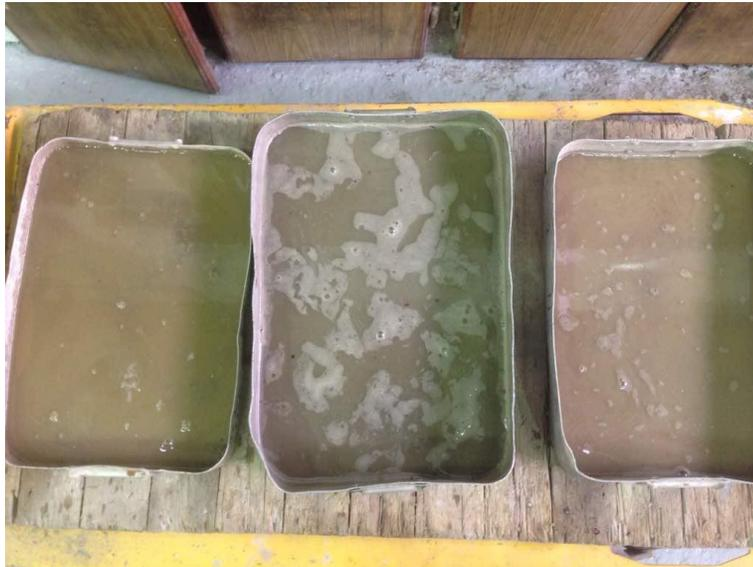
FIGURA 3.4. Saturación de agregado fino, para ensayos de peso específico y porcentaje de absorción.
