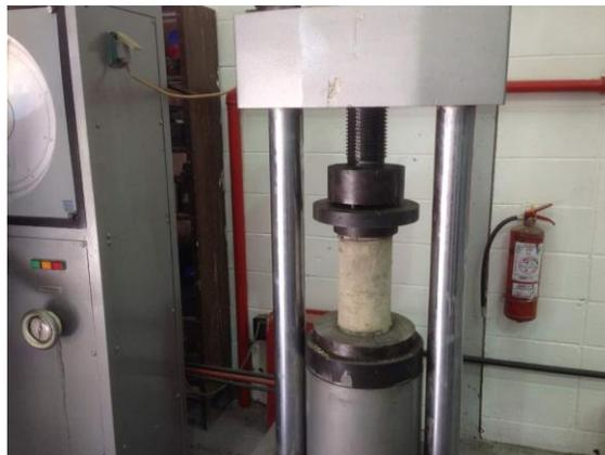
FIGURA 3.7. Ensayo de probeta cilíndrica a compresión.
