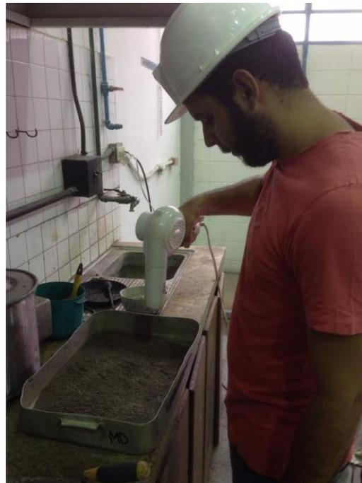
FIGURA 3.3. Secado superficial para ensayo de Peso específico y porcentaje de absorción.
