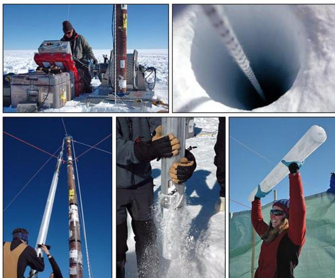
**Figura II-2: Perforación y Extracción de Núcleos de Hielo en Groenlandia**
