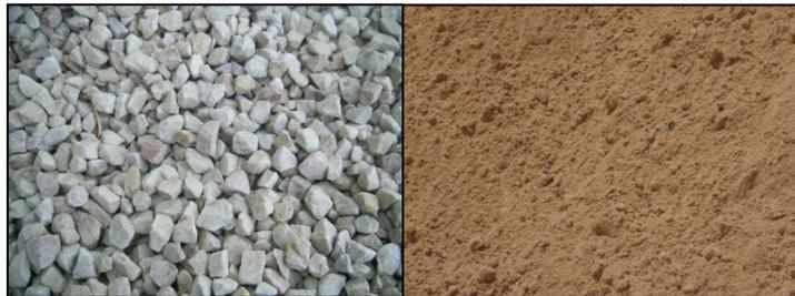
Figura N° 2. Agregados Fino y Grueso
