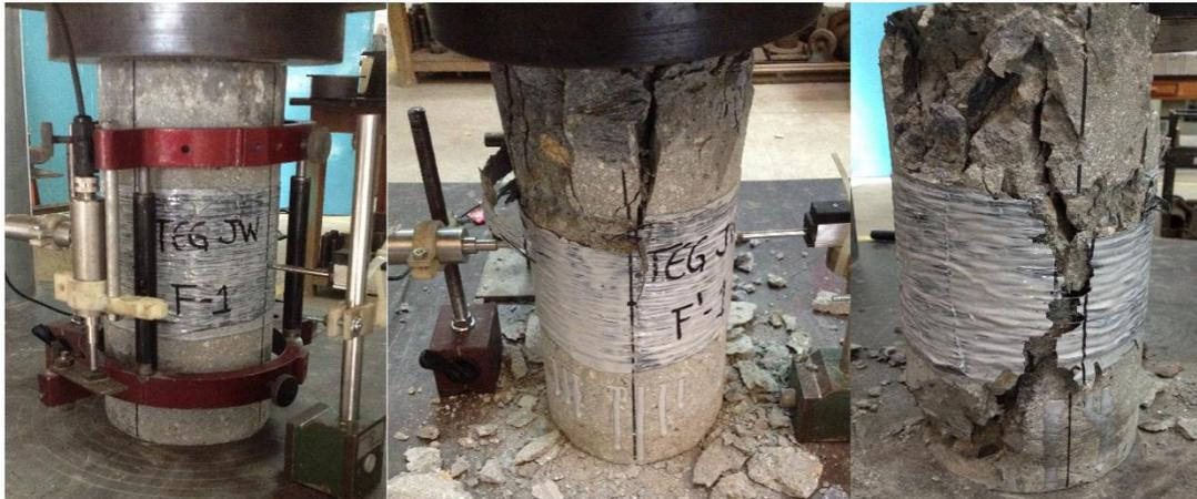
**Figura 4.3** Probetas ensayadas con 1/3 de altura confinada
