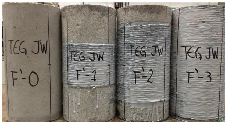
Figura 3.1 Probetas cilíndricas de concreto con exo – refuerzo
