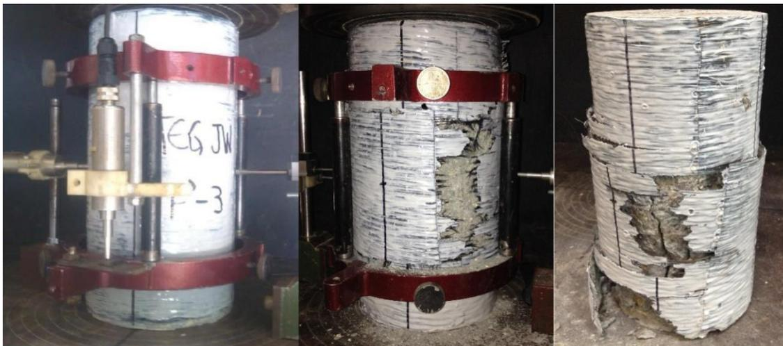
**Figura 4.7** Probetas ensayadas con la totalidad de la altura confinada
