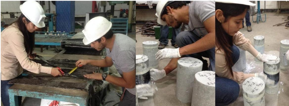
**Figura 3.3** Colocación fibra de carbono (CFRP)
