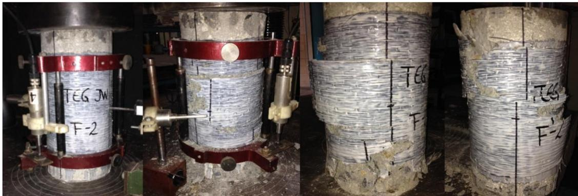
Figura 4.5 Probetas ensayadas con 2/3 de altura confinada
