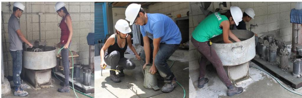
**Figura 3.2** Vaciado de probetas
