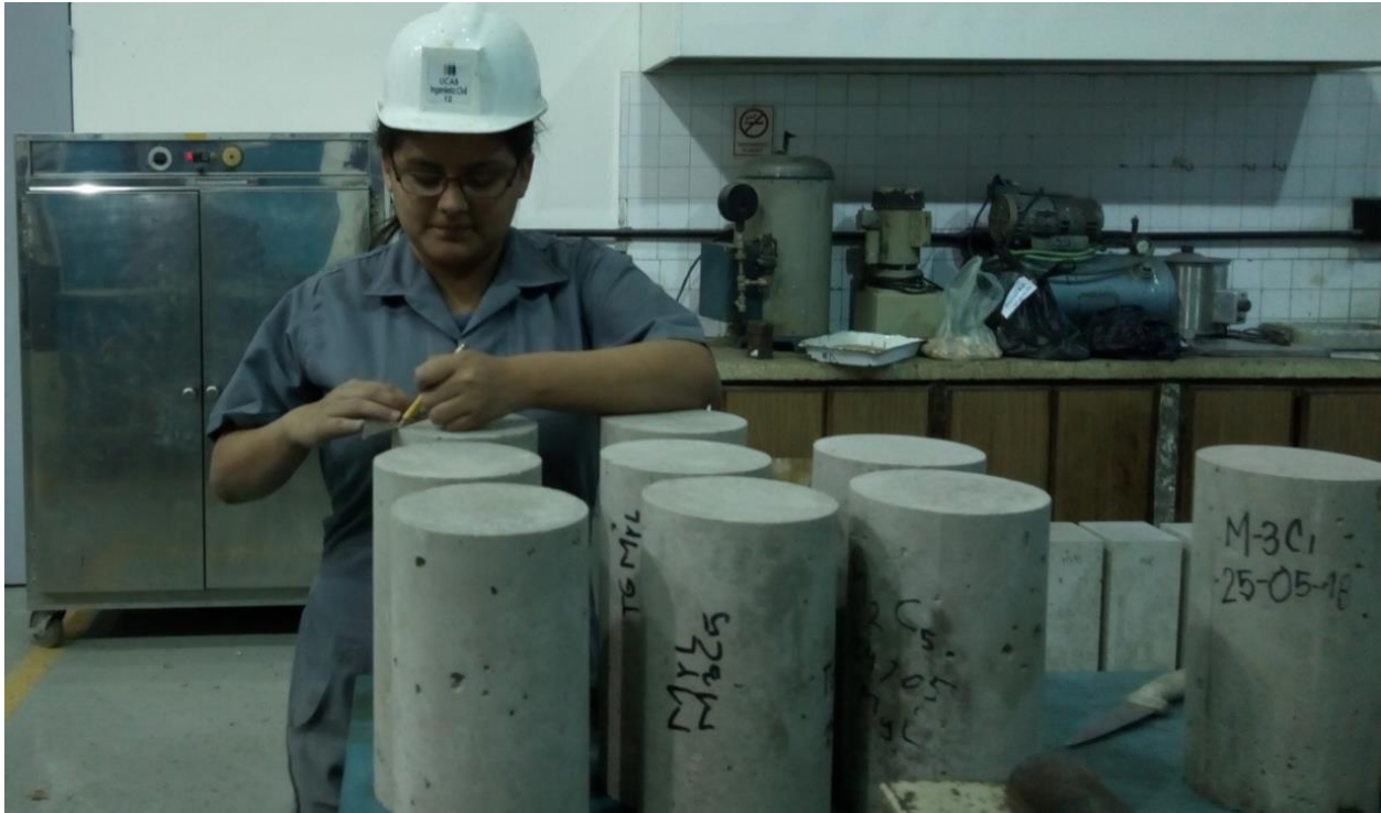
Figura III.4. Medición de Diámetros de Probetas
