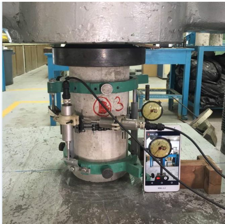
FIGURA III.5. Montaje de Equipos de Medición.
