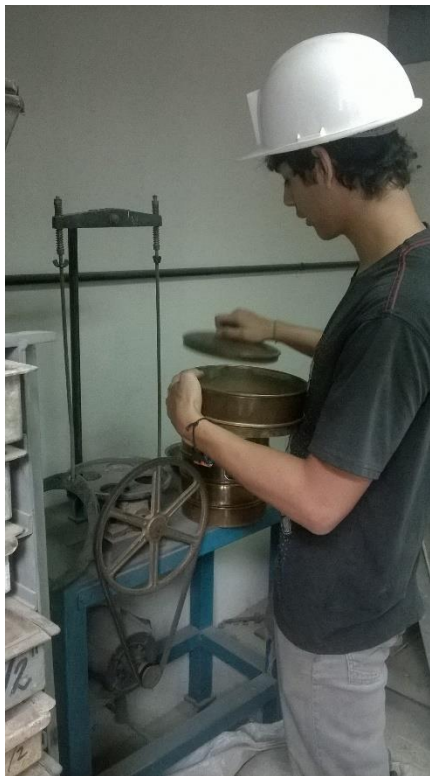
Figura 3.2 Realización de Granulometría de Finos.
