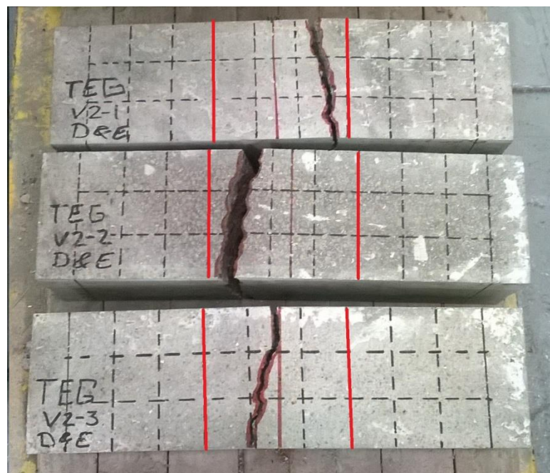
Figura 4.3 Falla de grupo Vaciado 3.
