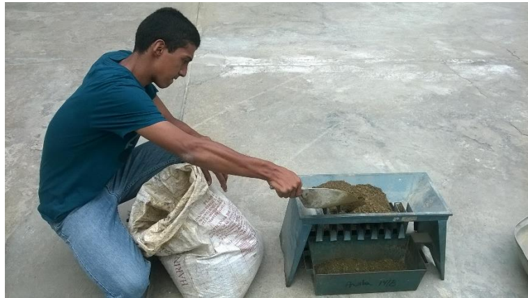
Figura 3.1 Cuarteo de Material para Granulometría de finos.
