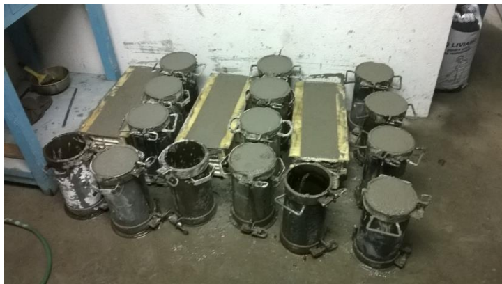
Figura. 3.3 Vigueta y los respectivos cilindros, para el segundo vaciado.
