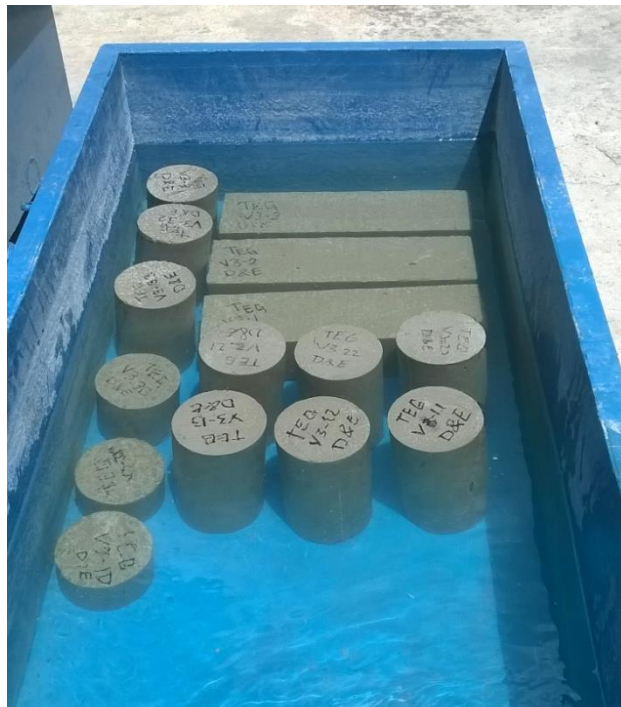
Figura 3.4 Probetas curadas en condición de 100% de humedad.
