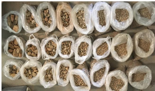
Imagen 6.2.31. Muestras pasante tamiz #10 para ensayo de Límites de Atterberg.
