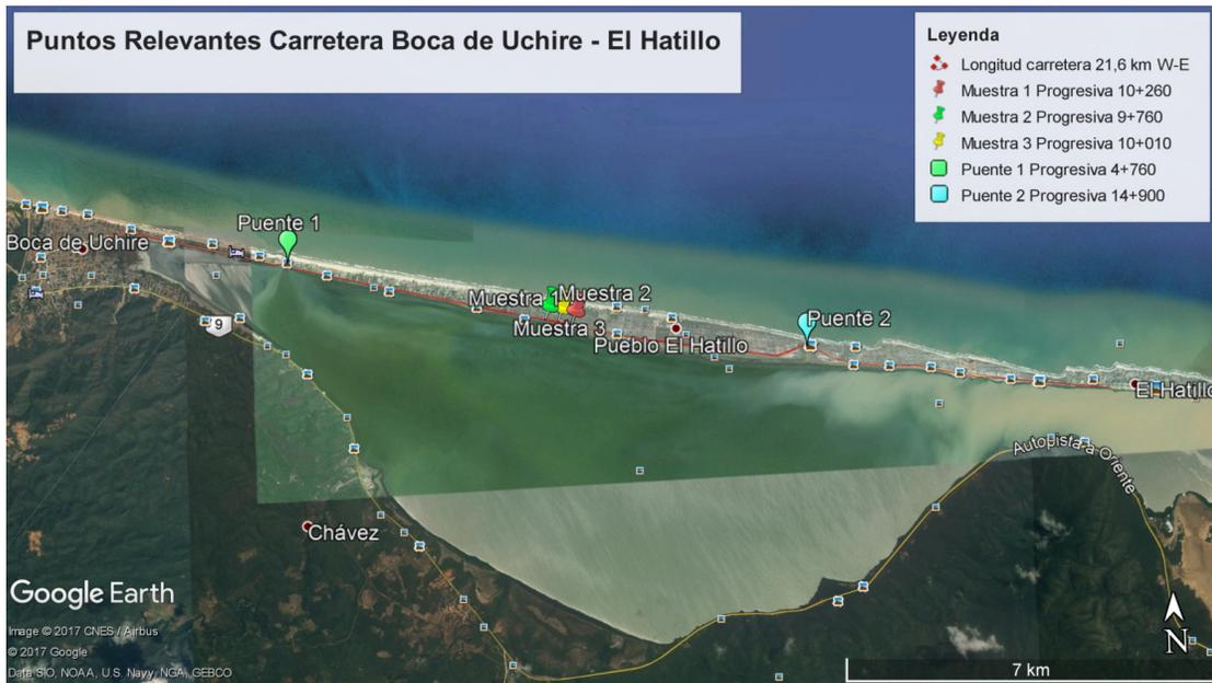
Para conocer las condiciones geo-ambientales actuales del suelo de fundación de la vía de referencia, se caracterizaron, a través de la realización de ciertos ensayos de laboratorio, tres muestras de suelo tomadas en un rango de 500 metros, los cuales también son necesarios para la propuesta de diseño de pavimento.
