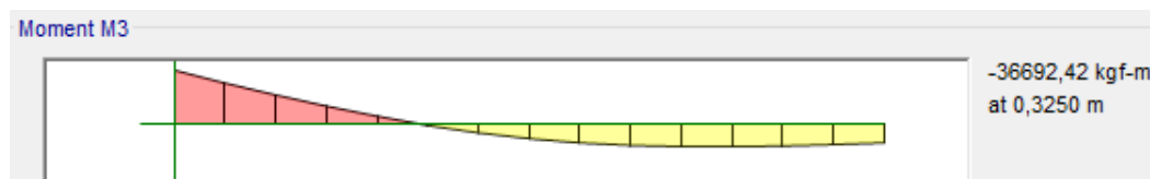
Imagen 49. Momento del análisis de colapso progresivo HI / P-7.
