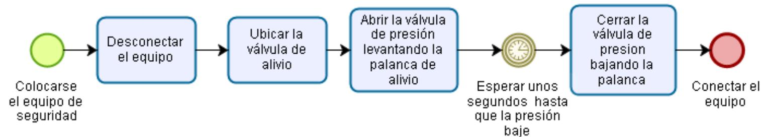
**Anexo M.19:** Diagrama de Flujo del proceso para abrir la válvula de alivio de presión de la marmita.
