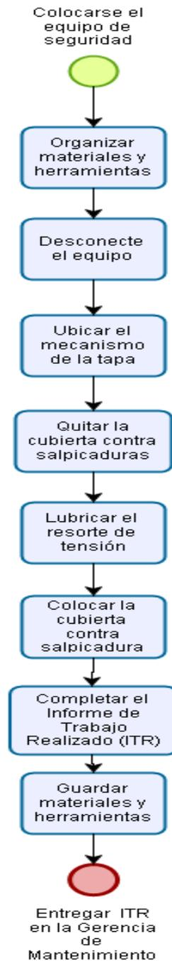
**Anexo M.2:** Diagrama de flujo del proceso de Lubricación del mecanismo de la tapa (bisagra) del Sartén Basculante.
