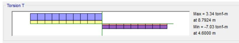
**Figura # 35** – Diagrama de torsión – Diafragma flexible con fachada de muros de concreto.
