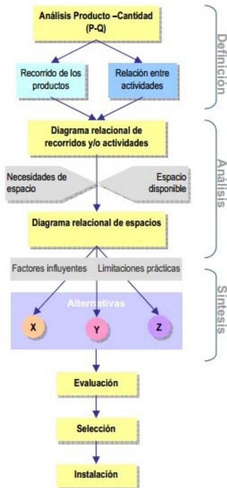
Figuras #9. Esquema del Systematic Layout Planning.
