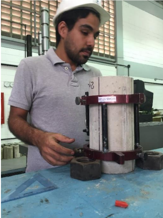
Figura III-15: Instalación del equipo para sujetar el medidor de dial.
