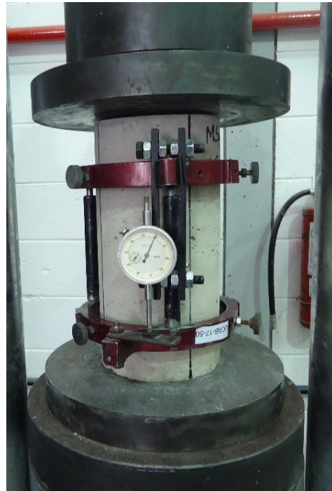
Figura III-15: Instalación del equipo para sujetar el medidor de dial.
