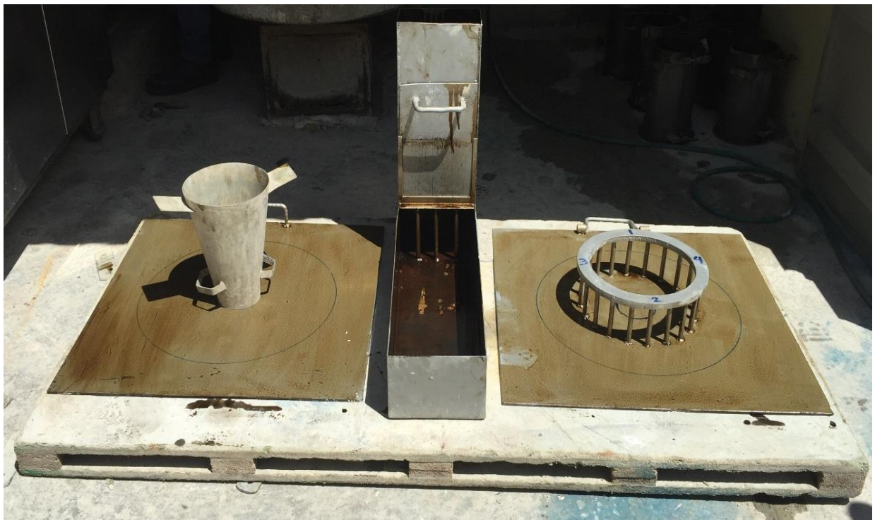
Figura III-5: Equipos preparados para el inicio de los vaciados.
