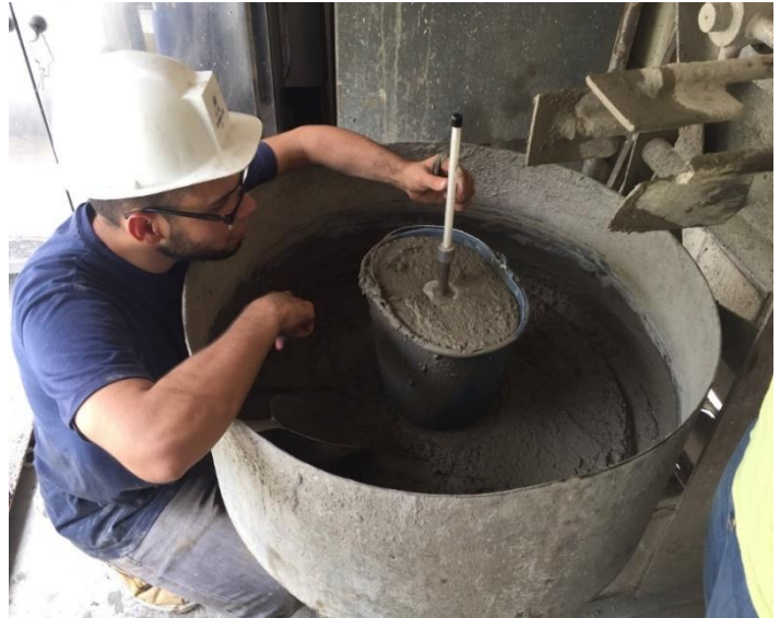
Figura III-11: Ensayo Medición de K Slump.
