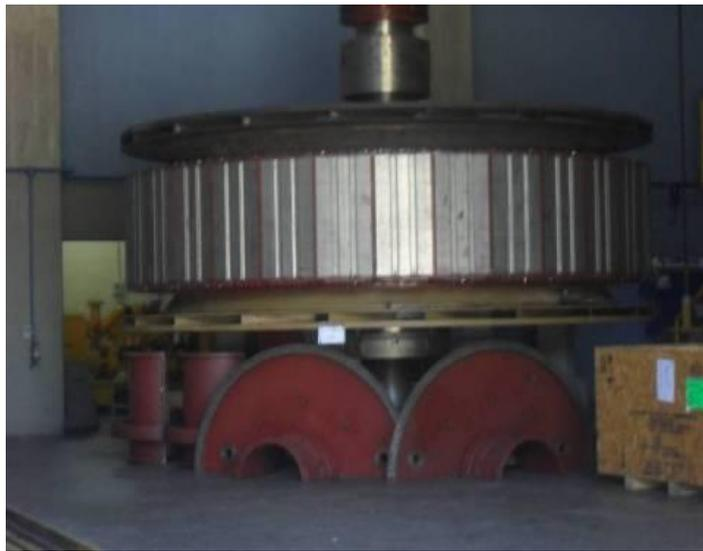
*Figura 3.18: Generador del embalse Boconó en reparación.*
