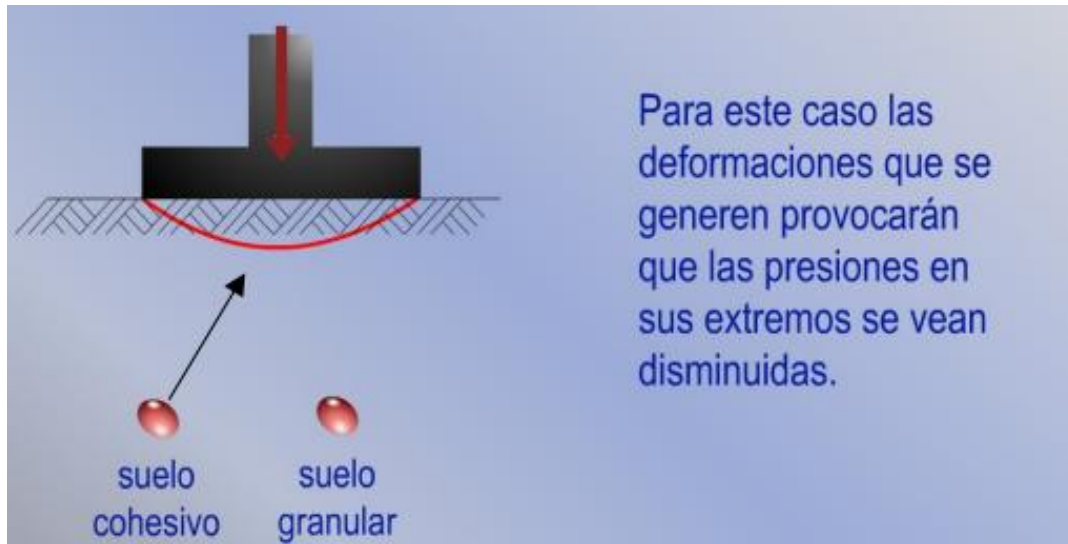
Figura 7. Distribución de Presiones en suelo Cohesivo
