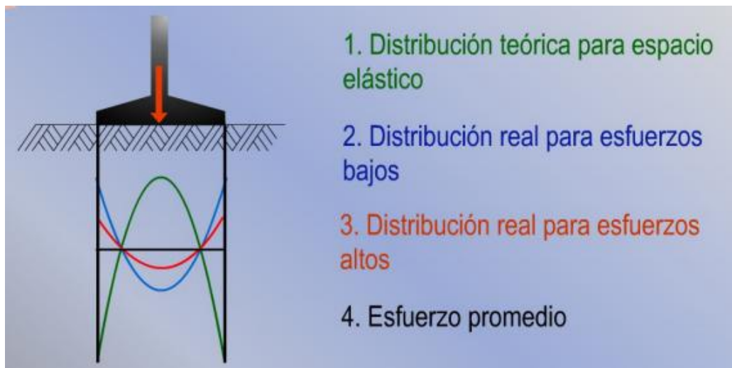
Figura. 6. Zapata Rígida en Suelo Granular.
