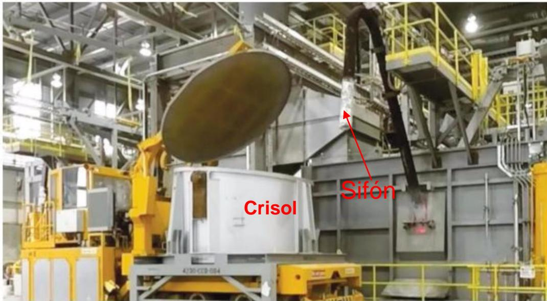
**Figura 9. Vaciado de un crisol mediante el método del sifón.** Tomado de Riverin, G., Tardy-Berger, N., L'Heureux, S., Simard, M. y Torman, M. (2015). Compact casthouse: New high productivity arrangement for small ingots production in Kitimat. *Aluminium International today*, 27(6), 23-25.
