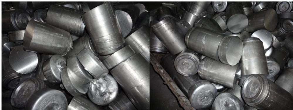
***Figura 61.*** Despunte de cilindros en la sierra de corte luego del proceso de homogeneizado.
