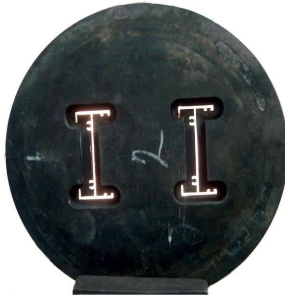
**Figura 23.** Matriz de extrusión con dos «bocas» u orificios de salida del material extruido. A medida que se reduce la abertura de salida para obtener perfiles de muy bajo espesor, más estricto debe ser el control de las inclusiones. Fuente: fotografía tomada por el autor.
