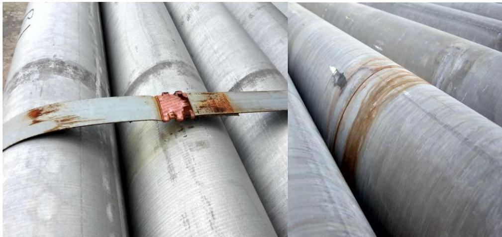
**Figura 65.** Embalaje de cilindros de una aleación 6063 mostrando un fleje oxidado (Foto izquierda). Este óxido mancha fácilmente la superficie del cilindro al estar expuesto a la intemperie (Foto derecha). Fuente: fotografías tomadas por el autor.
