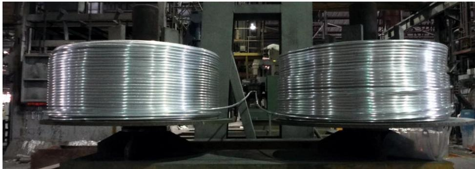
**Figura 25. Refinador de grano en forma de alambón (Tibor), inyectado directamente en la canal de colada.** Fuente: foto tomada por el autor.
