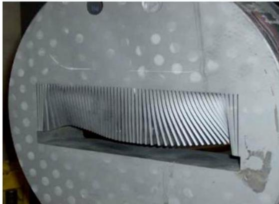
**Figura 83. Matriz de extrusión dañada.** Tomado de Chen, A., Rosario, A. y Tozier, M. (2014, Marzo). *Aluminum extrusion design and the role it plays in high performance cooling solutions* [Presentación en línea]. Disponible: <https://www.designworldonline.com/webinar-aluminum-extrusion-design-role-plays-high-performance-cooling-solutions/> [Consulta: 2018, Febrero 12].
