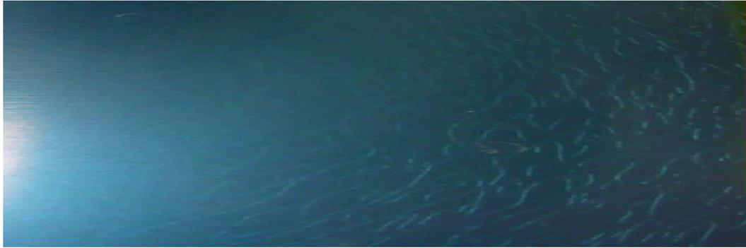
**Figura 99. Superficie de un perfil anodizado mostrando un patrón de finas grietas producto de un pobre estirado del perfil luego del temple.** Tomado de Hauge, T. (2014, Septiembre). *Influence of Al microstructure on hard anodising quality - profile material*. Ponencia presentada en The International Hard Anodizing Association 15th Technical Symposium, Ciudad de Nueva York.
