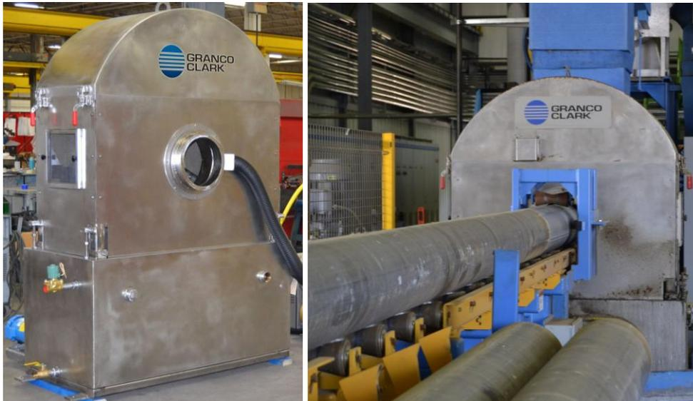
**Figura 93. Equipo especial para la limpieza superficial de los cilindros que entran al horno de precalentamiento.** Tomado de Granco Clark. (s.f.). *Hot-jet log & billet furnace* [Folleto en línea]. Disponible: [https://www.granoclarck.com/media/uploads/pdf/granco\\_clark\\_hot\\_jet\\_furnace.pdf](https://www.granoclarck.com/media/uploads/pdf/granco_clark_hot_jet_furnace.pdf) [Consulta: 2018, Febrero 19].
