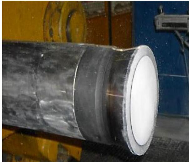
**Figura 85. Lubricación del disco de empuje con nitruro de boro.** Tomado de Klöpfer, C. (s.f.). *Boron nitride - solutions for aluminum extrusion* [Artículo en línea]. Disponible: <http://hetpan.net/3m%20images%20%20pdf/solutions-for-aluminum-extrusion.pdf> [Consulta: 2018, Marzo 01].
