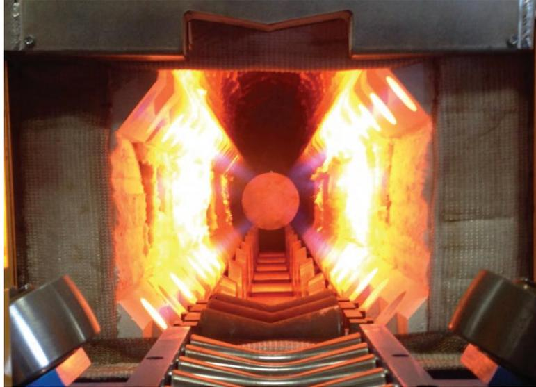
**Figura 75. Horno a gas tipo túnel para el precalentamiento de cilindros.** Tomado de Granco Clark. (s.f.). *Hot-jet log & billet furnace* [Folleto en línea]. Disponible: [https://www.grancoclark.com/media/uploads/pdf/granco\\_clark\\_hot\\_jet\\_furnace.pdf](https://www.grancoclark.com/media/uploads/pdf/granco_clark_hot_jet_furnace.pdf) [Consulta: 2018, Febrero 19].
