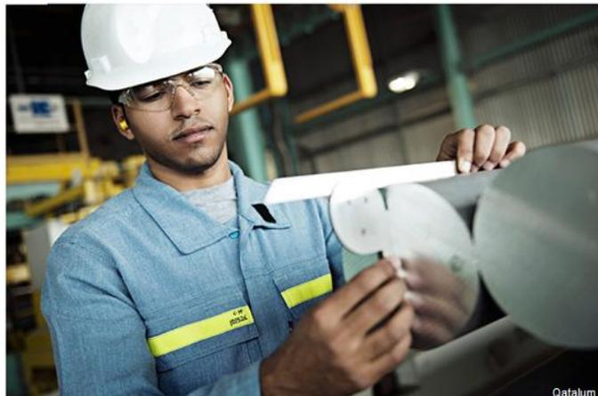
**Figura 62.** La rectitud en el corte de cilindro debe ser de  $90^\circ \pm 0,5^\circ$  para que pueda ajustarse adecuadamente dentro del contenedor de la prensa de extrusión. Tomada de Qatalum. (2012). *Picture gallery* [Foto en línea]. Disponible <https://www.qatalum.com/Media/Pages/Picture.aspx> [Consulta: 2012, Noviembre 18].
