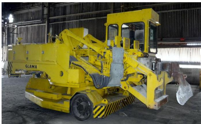
**Figura 15.** Vehículo especial para hacer operaciones de desnatado, batido y limpieza de las paredes y soleras de los hornos. Posee un brazo telescópico que le permite pararse frente a la puerta del horno y mantenerse estático mientras se ejecutan las operaciones. Fuente: fotografía tomada por el autor.
