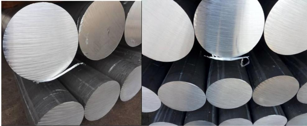
**Figura 63.** Vista de los extremos de un lote de cilindros mostrando la superficie cortada por la sierra, en donde se nota la presencia de virutas sin remover. Fuente: fotografías tomadas por el autor.
