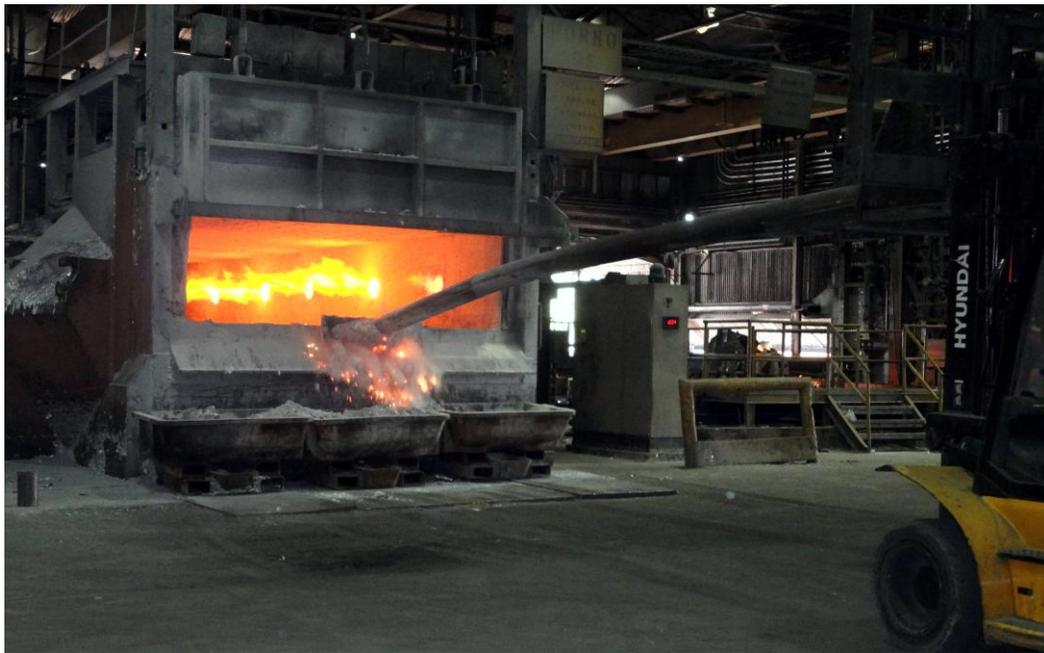
**Figura 12.** Operación de desnatado tradicional de un horno de retención. Se observa la herramienta llamada paleta acoplada a un montacargas. Para batir el horno también se requiere de una paleta similar. Fuente: fotografía tomada por el autor.
