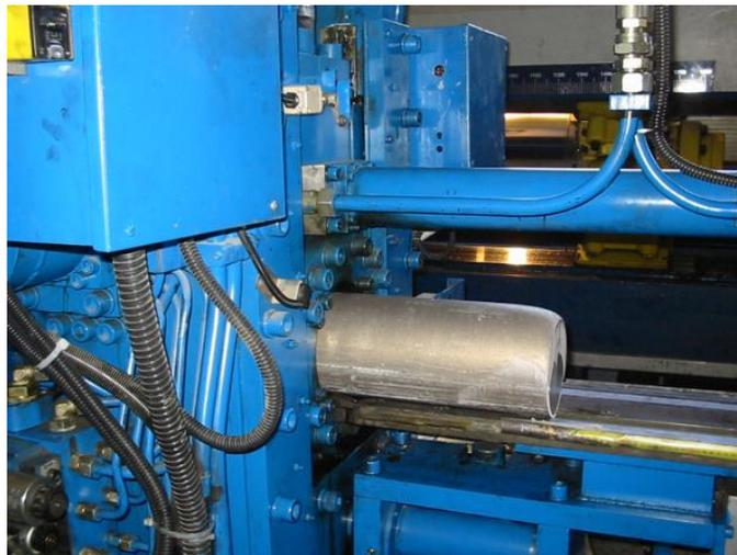
**Figura 80.** Cizalla de corte en caliente mostrando un tocho cortado a una longitud apropiada, también se observa cierta deformación en el extremo del tocho producto del corte. Tomado de SGE. (s.f.). Hot log shear [Fotografía en línea]. Disponible: <http://www.sge.co.th/en/maketoorders/18-hot-log-shear> [Consulta: 2018, Febrero 18].
