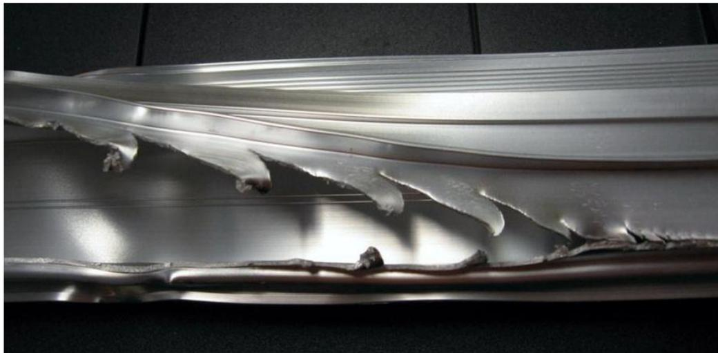
**Figura 22. Desgarramiento debido a la presencia de inclusiones en un perfil fabricado a partir de un cilindro de 7 in de diámetro de la aleación 6063.** Tomado de Easley, M. (2009, Octubre). *SEM/EDS analyses - MI metals, extruded alloy 6063 samples made with Venelum metal*. New Kensington, PA: Alloy Technology and Material Research.
