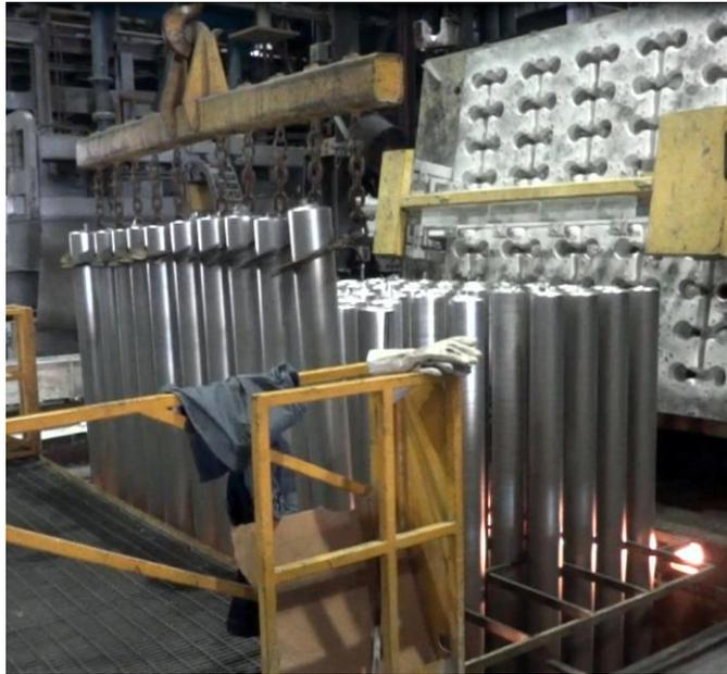
**Figura 40.** Extracción de cilindros de la fosa luego de finalizado el proceso de colada. Los cilindros luego serán inspeccionados con ultrasonido. Fuente: fotografía tomada por el autor.
