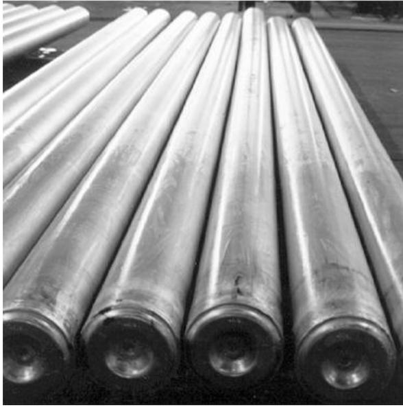
**Figura 58.** Cilindros de una aleación 6063 extraídos de la fosa de colada. Se observa que algunos están arqueados o curvados hacia el extremo del cilindro. Fuente: fotografía tomada por el autor.
