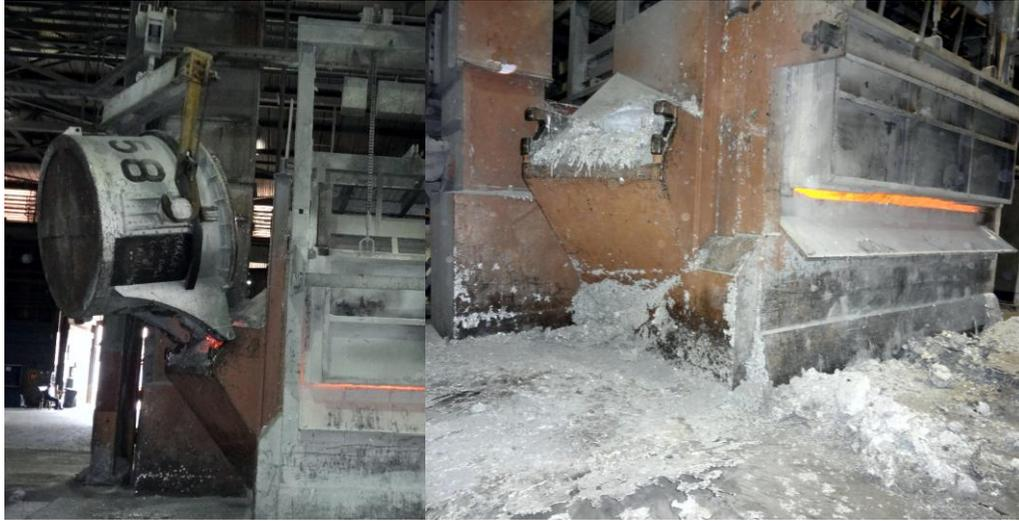
**Figura 8.** La foto izquierda muestra el vaciado de un crisol en la boca de carga de un horno de retención de tipo reverbero, mientras que la foto de la derecha muestra el derrame de aluminio alrededor de la boca de carga como consecuencia de un mal vaciado del metal. Fuente: fotografías tomadas por el autor.
