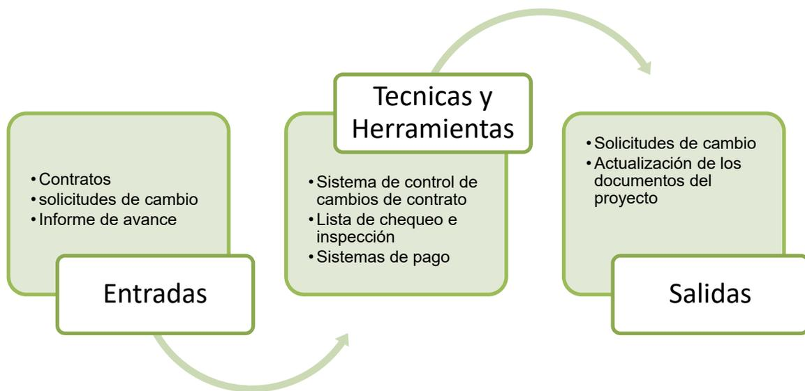
Grafico 5.12 Entradas, técnicas y herramientas, y salidas del proceso Controlar los recursos del proyecto de construcción.
