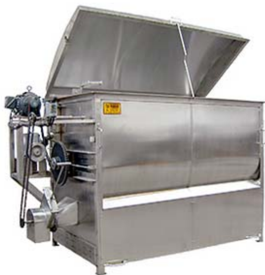
Figura 15. Cocina automática para hervir el maíz.
