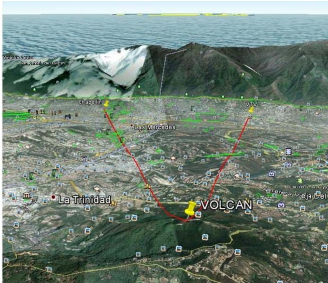
Figura 38: Vista satelital de radioenlace RNV – VTV – Con punto de repetición en Volcán
