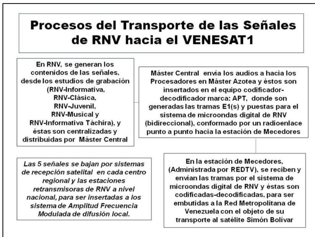
Figura 1 Esquema de generación y transporte de señales de audio RNV.
