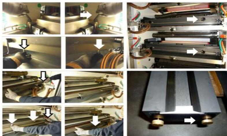
**Figura 9:** Elementos de sujeción de los Equipos Auxiliares en la máquina Flexográfica
