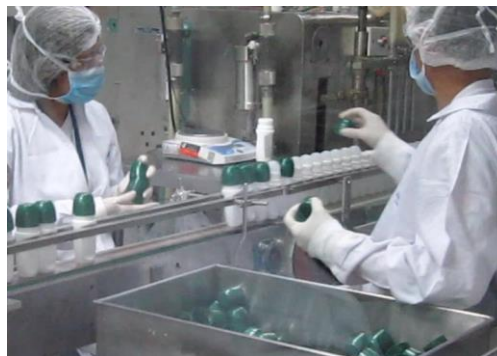
Figura 12. Estación de colocación de tapas
