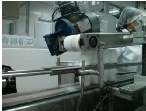
Figura 13. Estación de bajado de esferas
