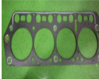
**Figura16. Empacadura de la cámara de combustión**
