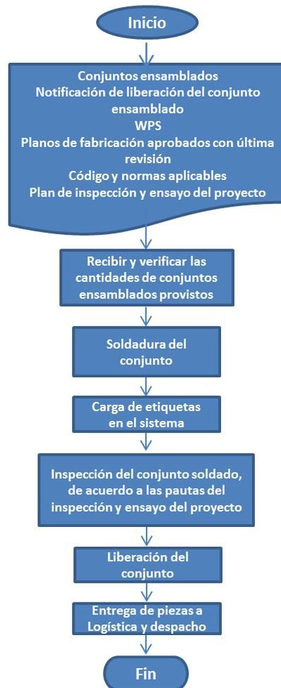
**Figura 6. Flujograma del proceso "soldadura".
