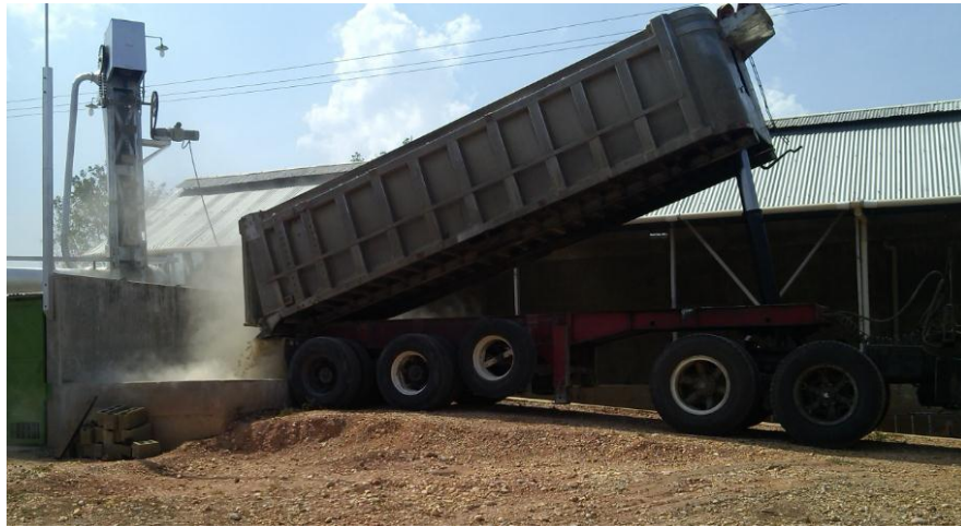
Figura 8 Alimentación a la tolva de recepción de la empresa CALCA
