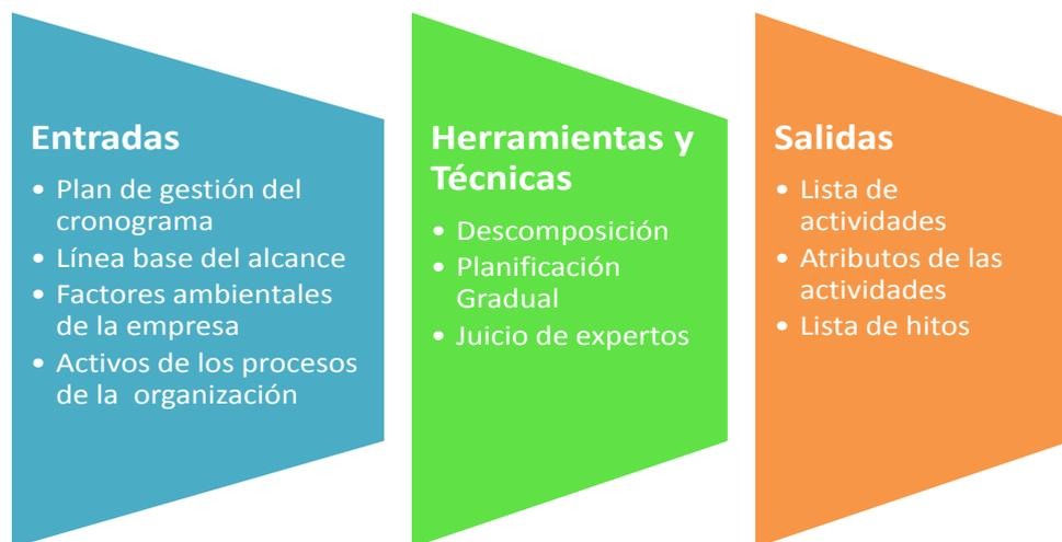
Figura 9 Entradas, herramientas y técnicas y salidas del proceso definición de actividades
