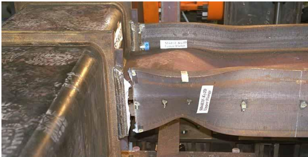
Figura I.6 Ensayo emanado de la investigación del AIJ Architectural Institute of Japan en el proyecto denominado Kinki Steel Project
