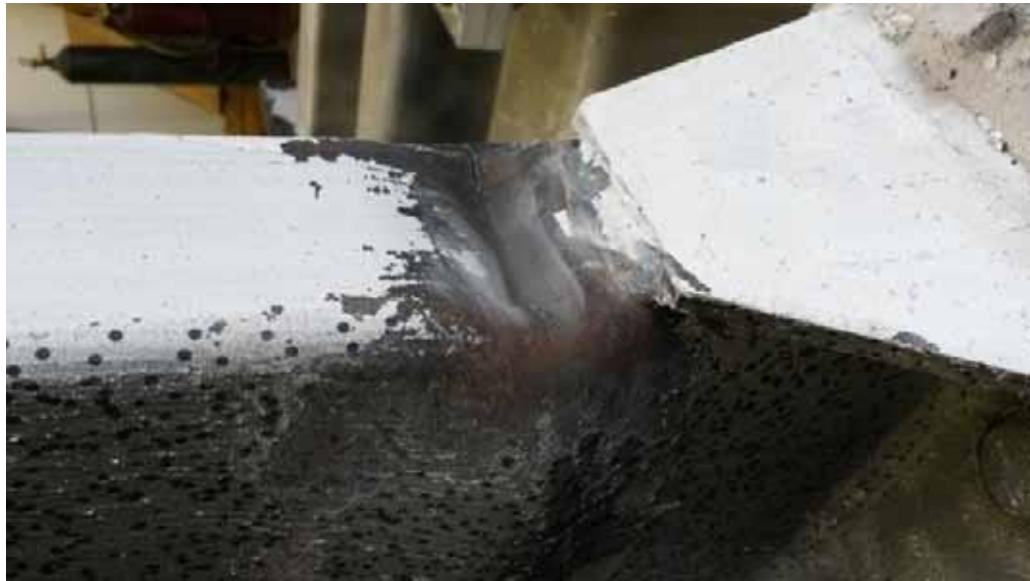
Figura VI.35 Agrietamiento final del ala del perfil tubular rectangular usado como viga. Ensayo #2.
