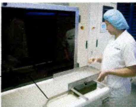
FOTO 3: COLOCACIÓN DE LAS AMPOLLAS EN LA CINTA TANSPORTADORA
