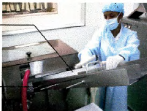
FOTO 1: OPERARIO COLOCANDO LAS AMPOLLAS EN LA LAVADORA BOSCH
