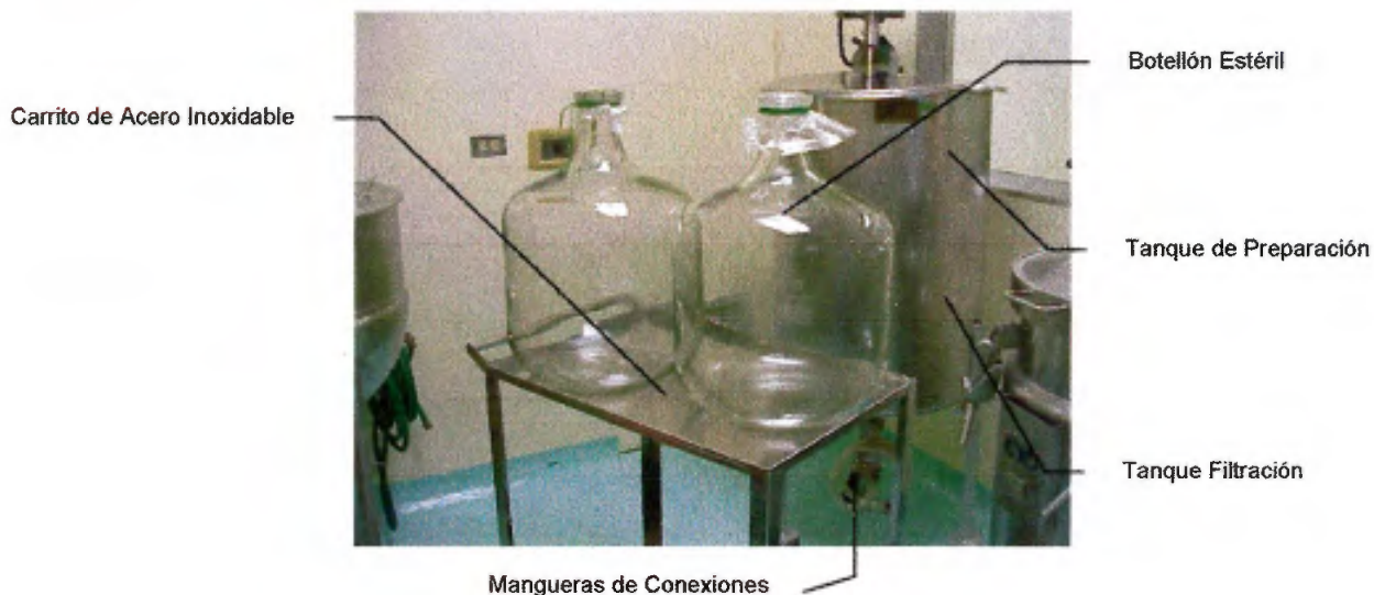
FOTO 1 UBICACIÓN DE LOS BOTELLONES Y EQUIPOS PARA EL LLENADO Y SELLADO DE LA SOLUCIÓN
